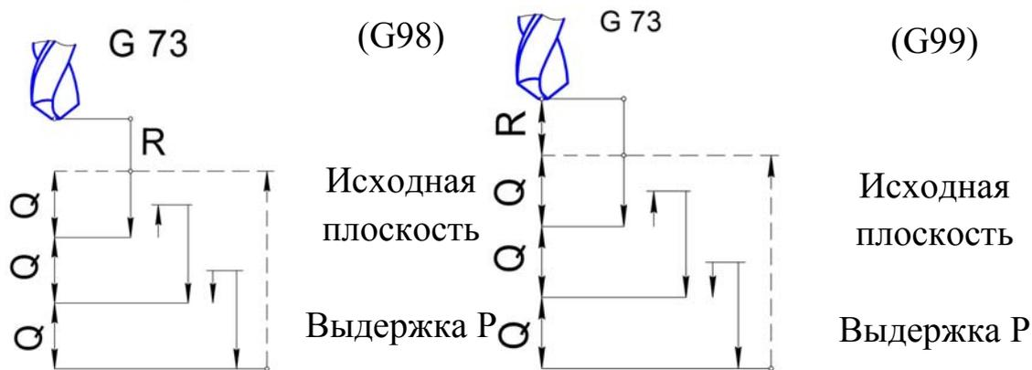
Рис. 4.30. Цикл сверления с отводом сверла в исходную плоскость
