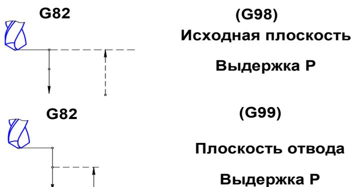
Рис. 4.34. Движения режущего инструмента при выполнении цикла G82
