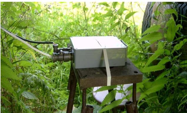
Рис. 4.1, г. Цифровая метеостанция на твердотельных датчиках
