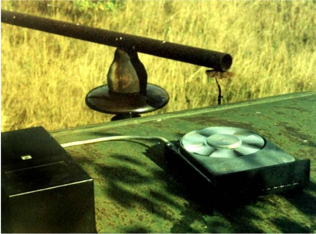
Рис. 4.1, а. Электростатический флюксометр с загерметизированной электронной частью
