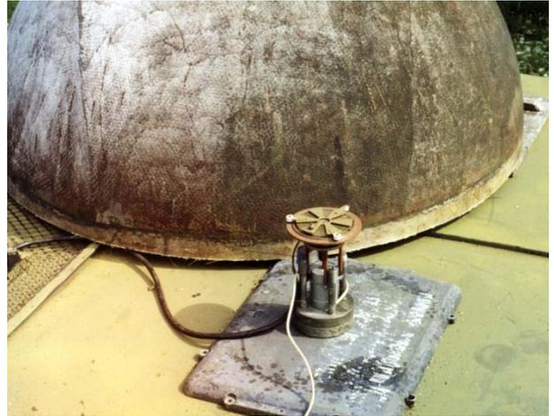
Рис. 4.1, б. Электростатический флюксометр с экраном
