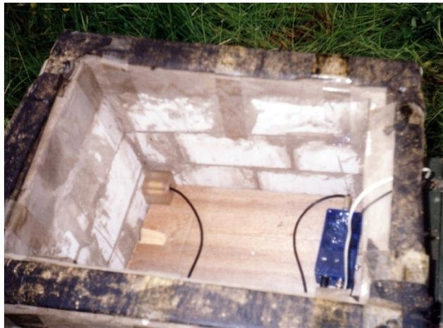
Рис. 4.1, в. Феррозондовый магнитометр
