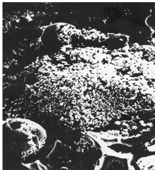
Рис. 2. Микроструктура пенокарбида кремния с добавкой 60% SiO 2 (увеличение в 500 раз). Температура обработки 1850 К
