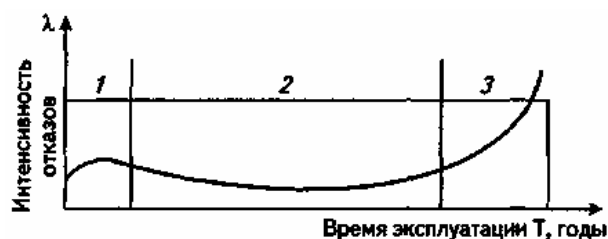
Рис. 1.1. Интенсивность отказов элементов как функция времени эксплуатации: 1 – период приработки; 2 – период нормальной эксплуатации (внезапные отказы); 3 – период интенсивного износа (внезапные и износные отказы)
