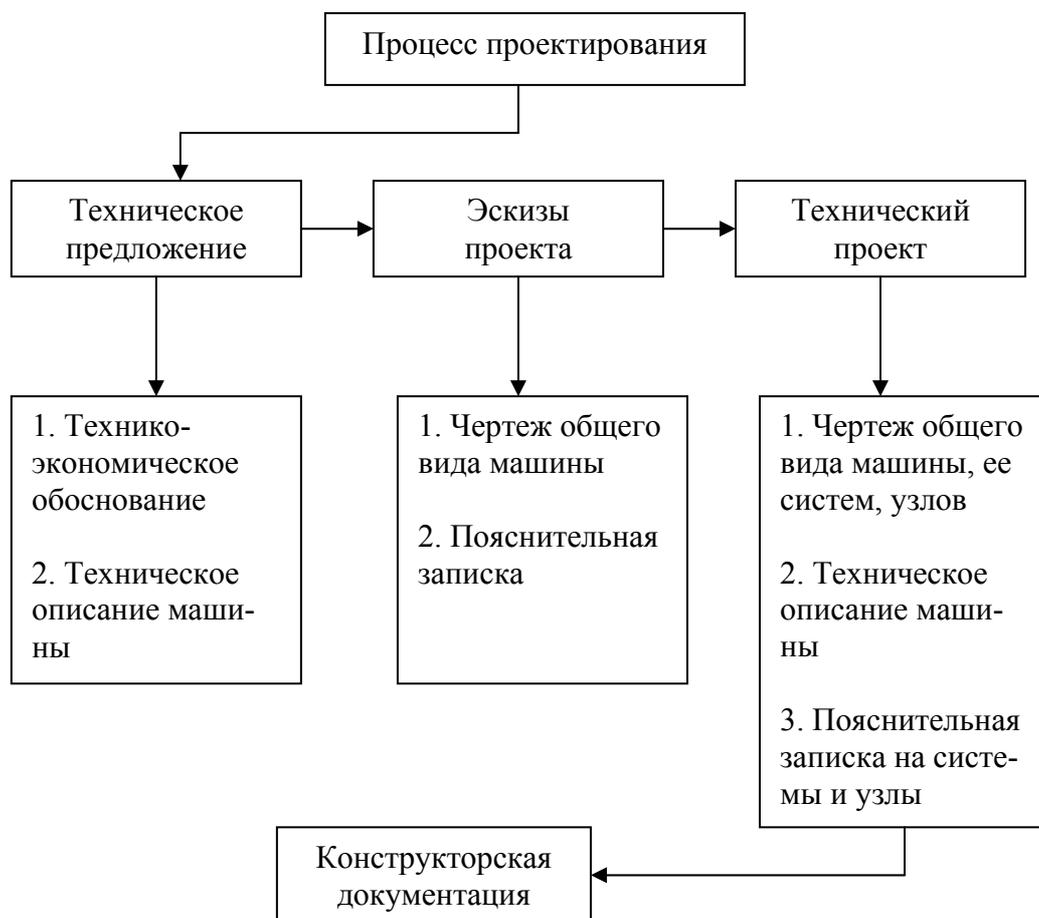
Рис. 5.1. Структура процесса проектирования машины
