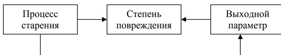
Рис. 2.16. Схема оценки степени повреждения по изменению выходных параметров
