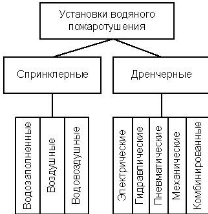
Рис. 2.4. Классификация установок водяного пожаротушения
