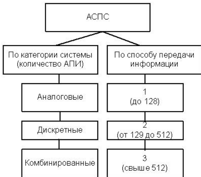
Рис. 2.8. Классификация адресных систем пожарной сигнализации
