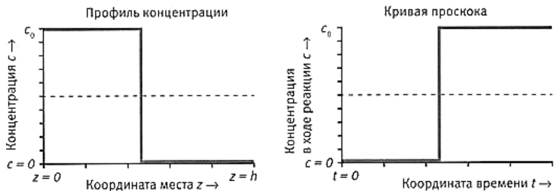
Рис. 4.24. Идеальная, или стехиометрическая, кривая проскока и идеальный профиль
