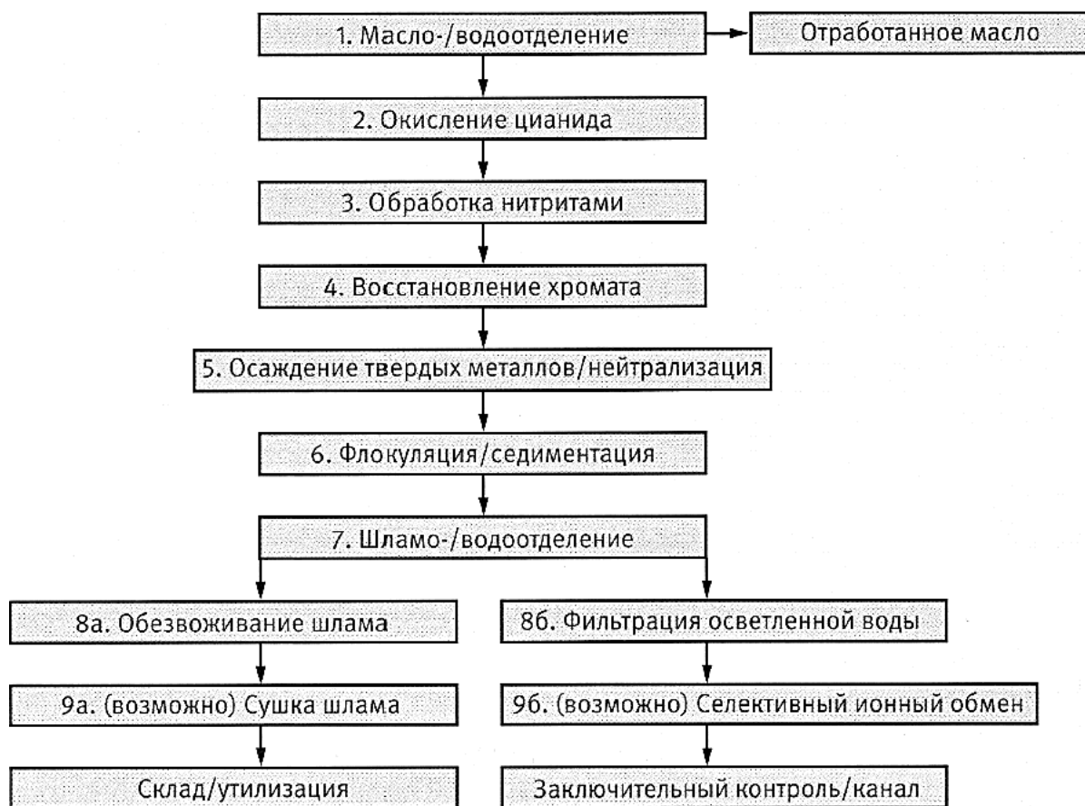
Рис. 6.36. Стадии процесса обработки для неорганически загрязненных сточных вод
