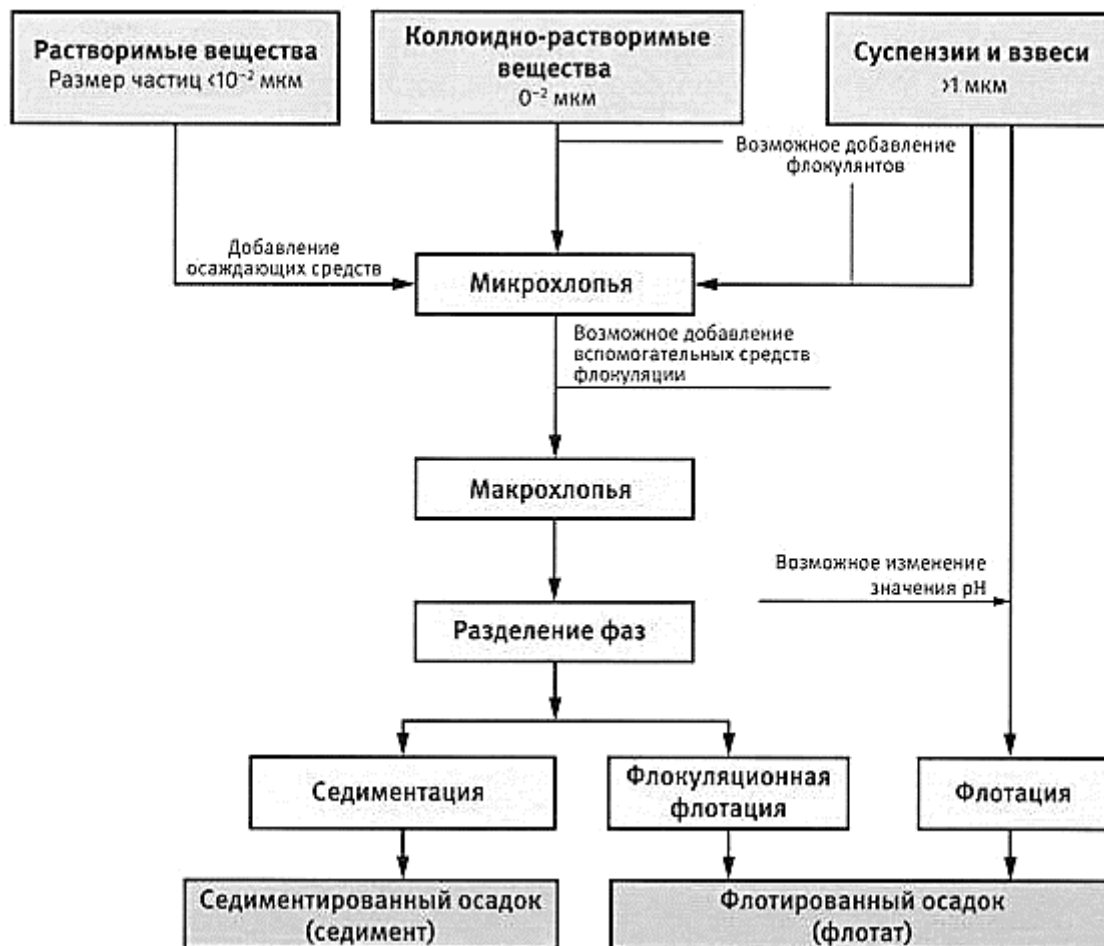
Рис. 4.10. Схема осаждения, флокуляции и разделения фаз
