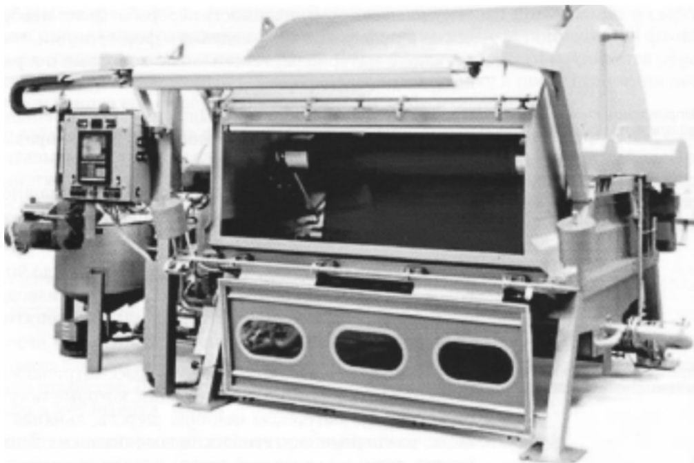
Рис. 6.23. Вытяжное крашение неотетразолийхлоридной ворсовальной машиной
