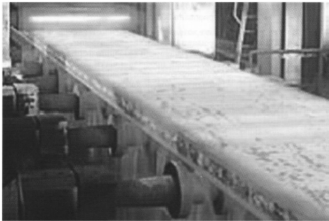
Рис. 6.42. Установка непрерывной заливки
