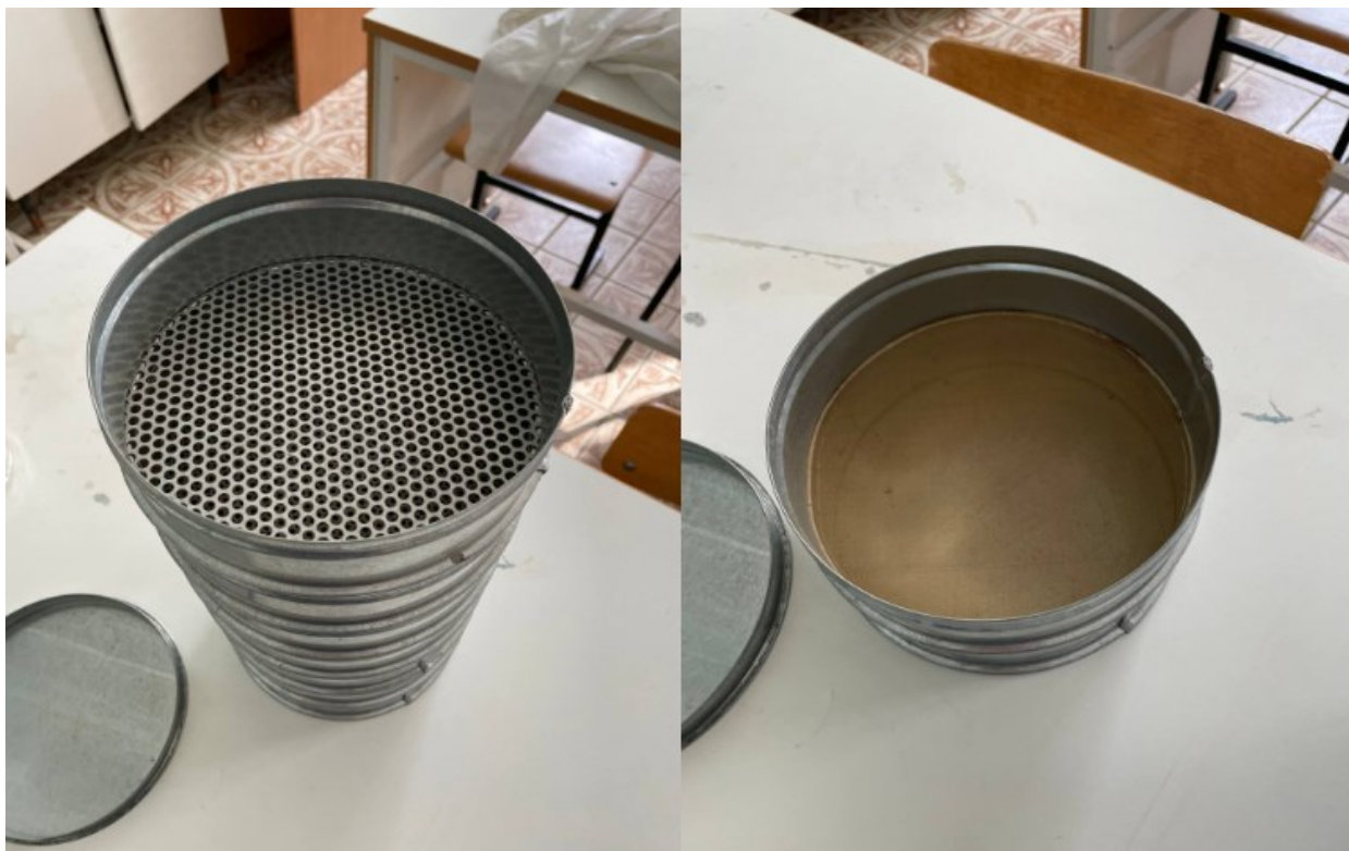
Рис. 2. Лабораторное сито с разным диаметром перфораций
