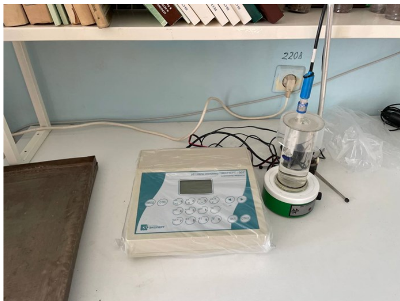
Рис. 5. Прибор для измерения кислотного уровня вытяжки (иономер)
