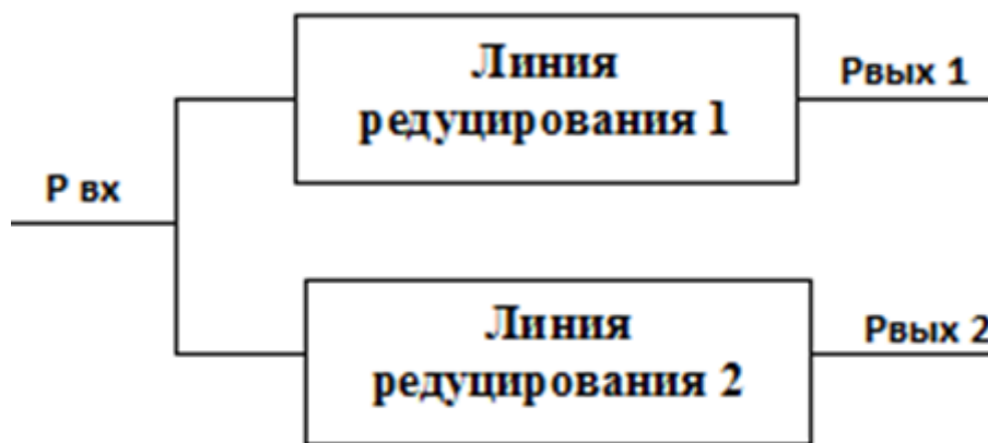
Рисунок 2 – Схема ПРГ с линиями редуцирования, настроенными на разное давление газа
