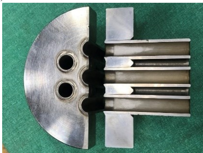
Рисунок 6 – Сварное соединение трубных решеток ГЦНА
