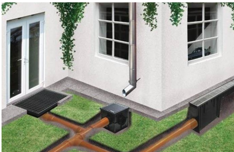
Рисунок 3 – Пример организации водостока бани в гаражном боксе
