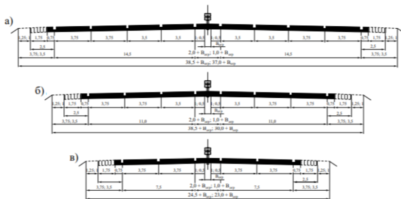
Рис. 2.90. Типовые поперечные профили дорог категории IV (а, б, в) (конструкция ограждения показана условно)
