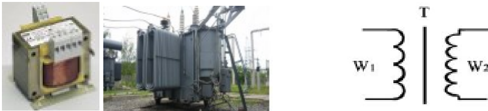
Рис. 7. Трансформатор (T, TV)
