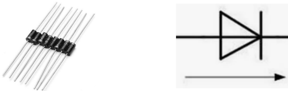
Рис. 4. Диод (VD, D)
