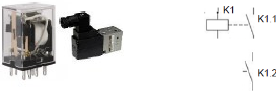
Рис. 8. Электромагнитное реле (K, Y), пускатель и контактор (KM)
