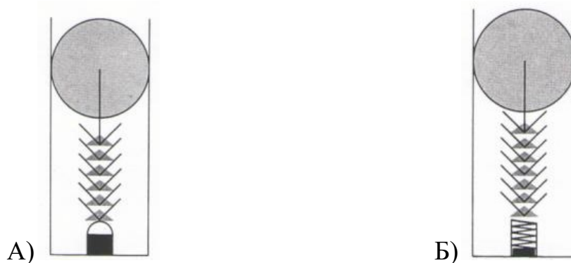
Рисунок 1. Конструкция простейших амортизаторов. А – резиновый бампер, Б – витая пружина.
