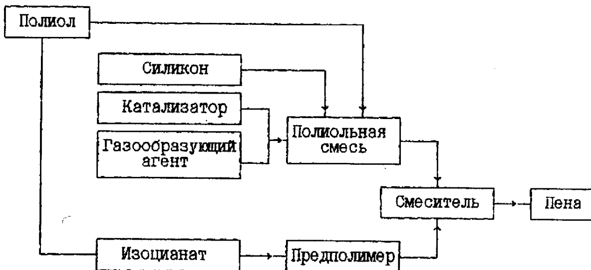
Рисунок 4.3. Квази-предполимерная система получения ППУ.
