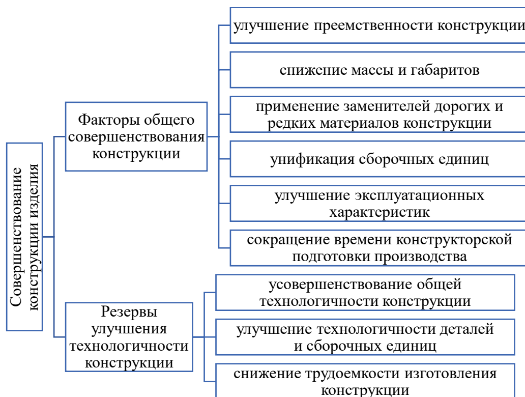
Рис. 3.8. Факторы совершенствования конструкции изделий
