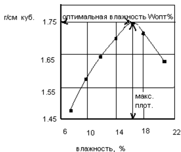
Рис. 9. Кривая стандартного уплотнения
