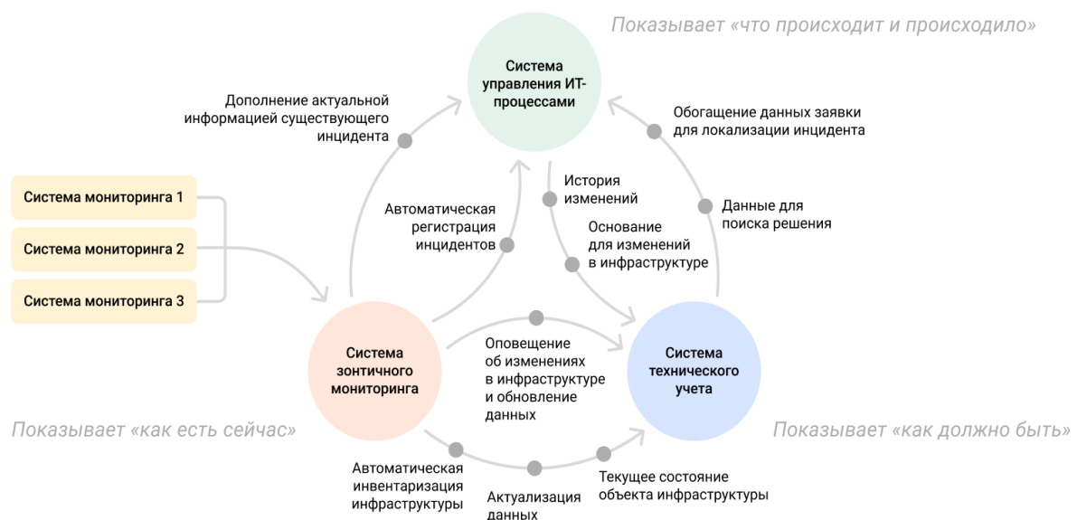
Рис. 1.4. Обобщенная концепция построения цифровой инфраструктуры компании при использовании современных фреймворков и стандартов
