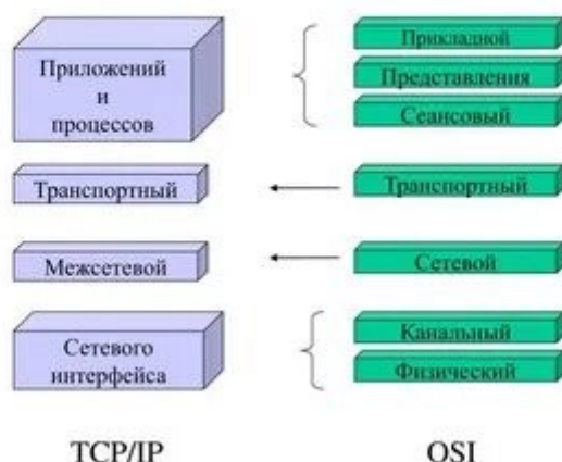
Рис. 1.8 Уровни стека протоколов TCP/IP
