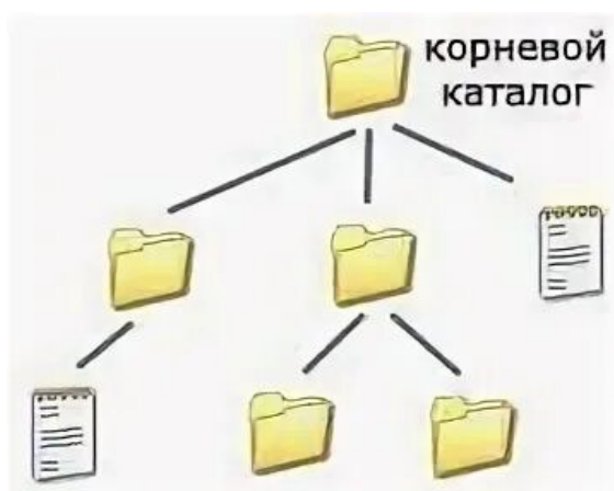
Рис. 2.4. Иерархическая (древовидная) структура на примере файловой системы
