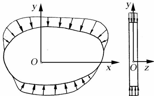
Рис. 18. Обобщенное плоское напряженное состояние
