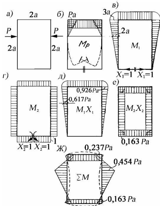
Рис. 1. Схема расчета замкнутого контура с одноосной симметрией
