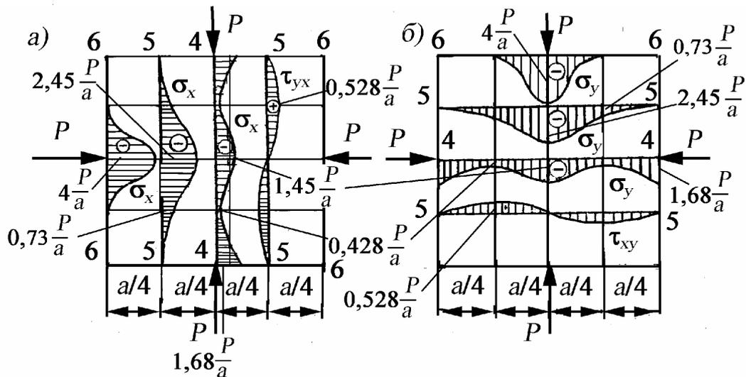
Рис. 34. Эпюры напряжений  $\sigma_x$  (а) и  $\sigma_y$  (б), построенных по расчетным данным
