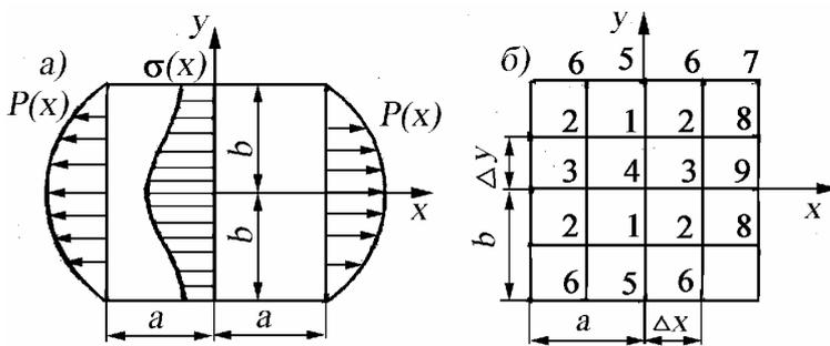
Рис. 36. Прямоугольная пластинка с приложенной по сторонам нагрузкой (а) и расчетная сетка (б)
