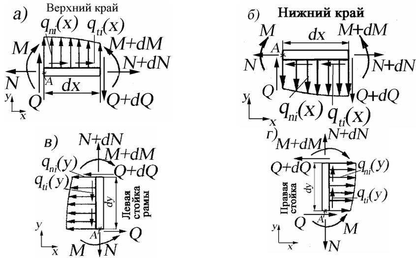
**Рис. 29.** К выводу дифференциальных зависимостей для верхнего края (а), нижнего – (б), левой (в) и правой (г) стойки рамы
