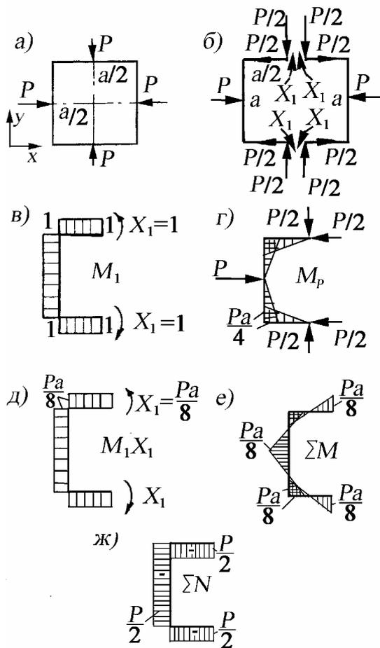
Рис. 32. Расчет рамы, равной по контуру балке-стенке
