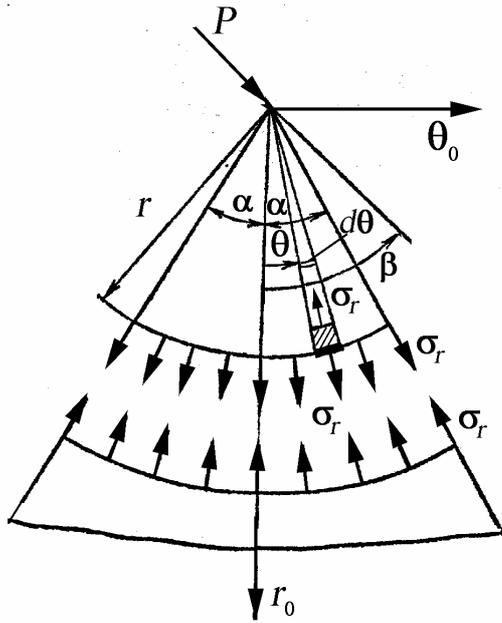
Рис. 38. Нагружение на участок клина произвольной силой
