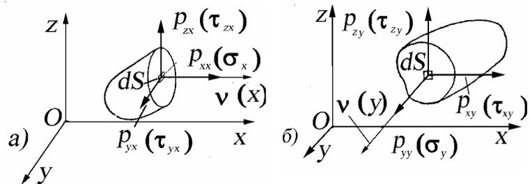
Рис. 3. Обозначение нормальных и касательных напряжений на площадках с нормальными, совпадающими с осями  $x$  (а) и  $y$  (б)
