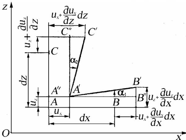
Рис. 13. Компоненты смещений концов ребер  $AB$  и  $AC$  при деформации элементарного параллелепипеда
