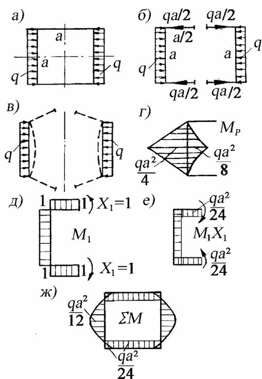
Рис. 2. Метод решения замкнутого контура с двухосной симметрией
