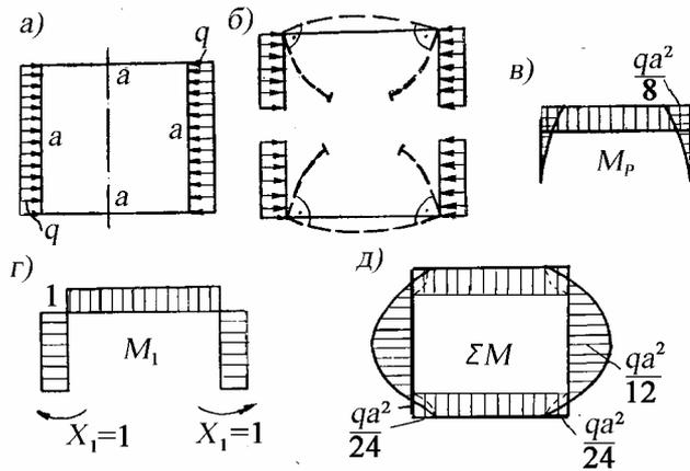
**Рис. 3. Варианты выбора основной системы при двухосной симметрии**
