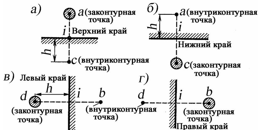
Рис. 27. К определению функции напряжений в законтурных точках
