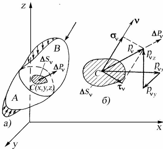
**Рис. 2. Определение напряжений в окрестности точки C**
