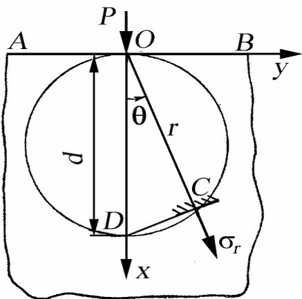
Рис. 40. Действие силы  $P$  на упругую полуплоскость
