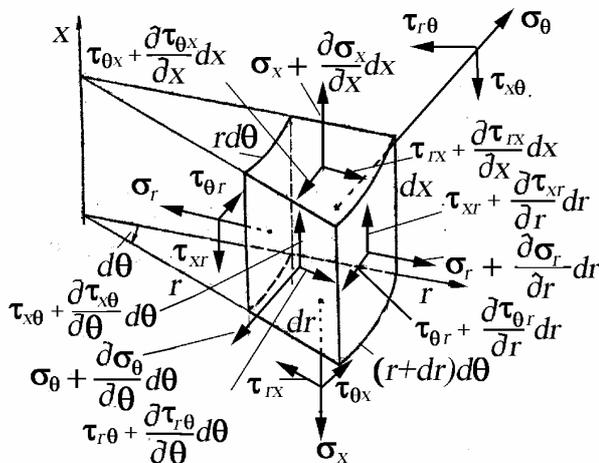
Рис. 5. Бесконечно малый элемент в цилиндрической системе координат
