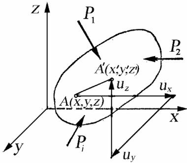
Рис. 12. Перемещение точки  $A$  под действием внешней нагрузки
