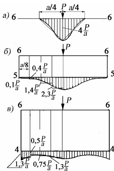
**Рис. 35. К равновесию отсеченных частей балки-стенки**
