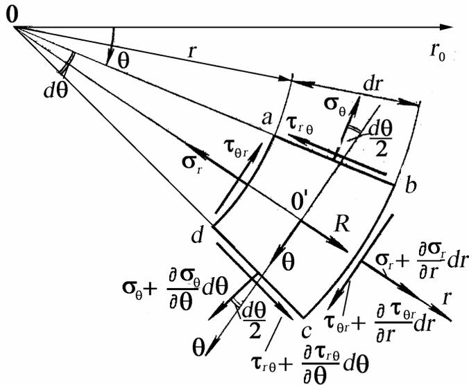
Рис. 37. Равновесие элементарного объема в полярной системе координат
