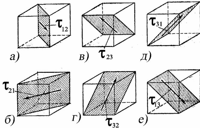
Рис. 9. Три пары площадок с относительными максимумами касательных напряжений: индексы  $i, j$  ( $i, j = 1, 2, 3$ ) на  $a$ - $e$  определяют, из разности каких главных напряжений определяется  $\tau_{ij}$
