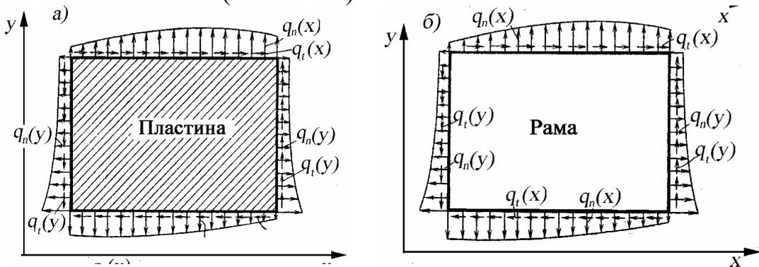
Рис. 28. Балка-стенка (а) с приложенной внешней нагрузкой и заменяющая ее рама (б)
