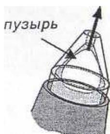
ного кольца, расположенного в нижней части зонда) выдавите газовый пузырь через канал наружу. Удалите капли электролита с наконечника бумажной салфеткой. Электролит должен полностью заполнить внутреннюю полость наконечника и, поднявшись
