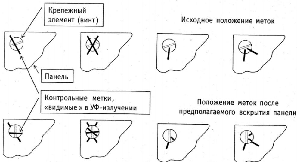
Рис. 1. Иллюстрация метода постановки и считывания контрольных меток с помощью специальных меточных средств
