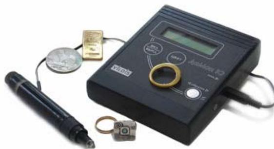
*Рис. 8. Общий вид электрохимического детектора ДеМон-Ю*
