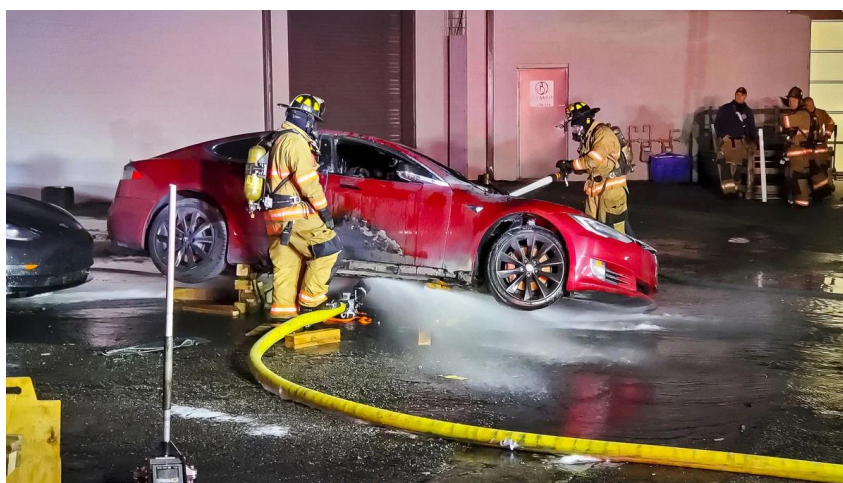
Рис. 2. Подача воды для аварийного охлаждения батареи электромобиля
