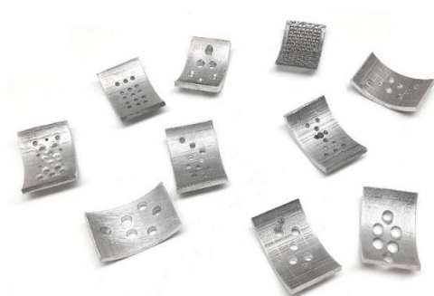
Рис. 2. Внешний вид вкладышей с улавливающими отверстиями различных размеров, формы и расположения
