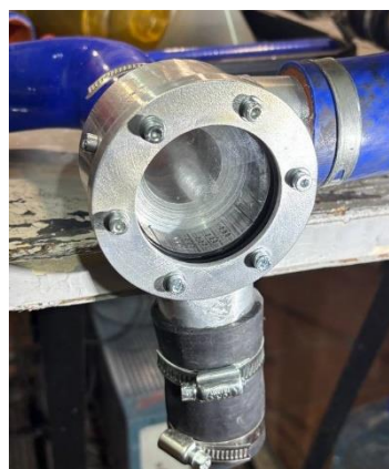
Рис. 1. Схема (а) и внешний вид (б) вихревой камеры лабораторной установки для исследования процессов сепарации частиц в закрученном потоке жидкости:
