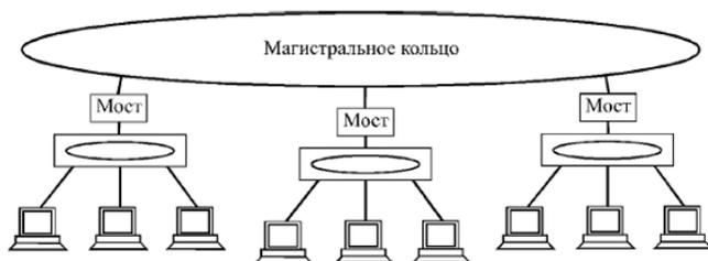
Рис. 11.13. Объединение сегментов магистральным кольцом с помощью мостов
