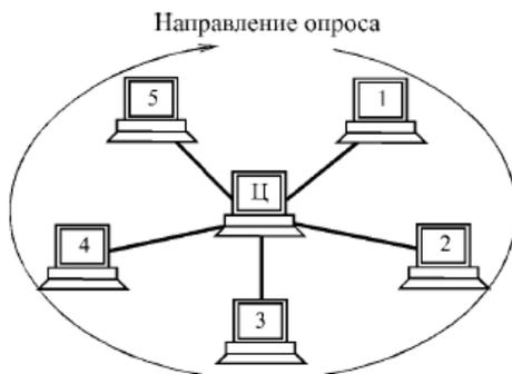
Рис. 5.1. Централизованный метод управления обменом в сети с топологией «звезда»
