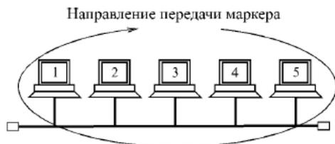
Рис. 5.9. Применение маркерного метода управления в шине
