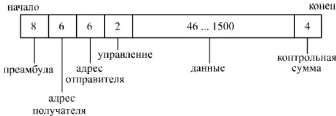
Рис. 11.2. Структура пакета сети Ethernet
