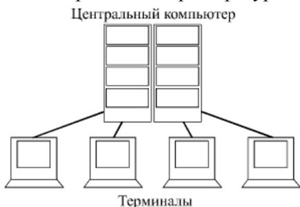
Рис. 2.1. Подключение терминалов к центральному компьютеру
