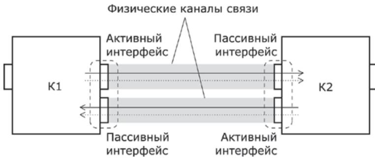
Рис. 6.6. Два однонаправленных физических канала
