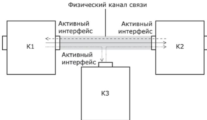
Рис. 6.8. Схема «общая шина»
