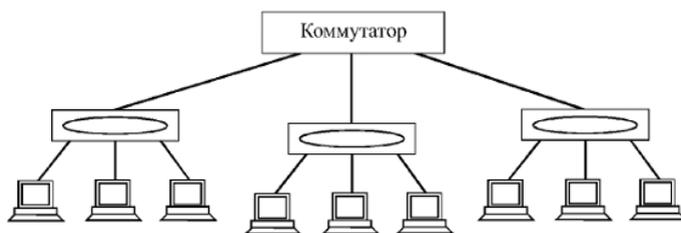
Рис. 11.14. Объединение сегментов центральным коммутатором
