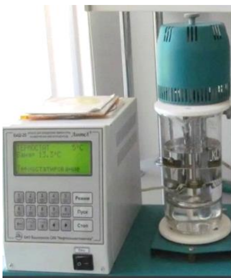
Рис. 5. Прибор «Кольцо и шар» (КиШ)
