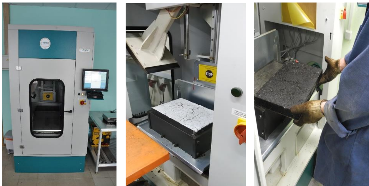
Рис. 11. Изготовление образцов-плит вальцовым (секторным) уплотнителем
