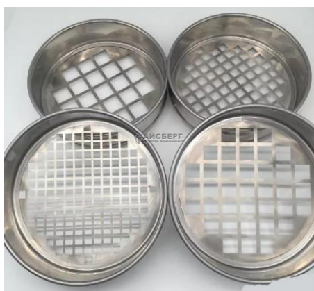
Рис. 1. Набор сит для определения гранулометрического состава щебня
