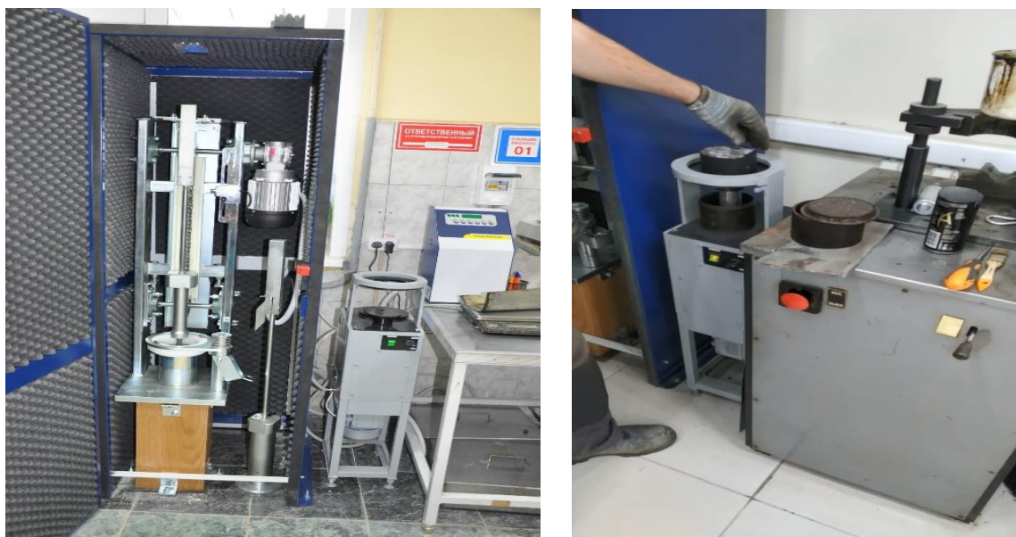
Рис. 10. Изготовление асфальтобетонных образцов (уплотнитель Маршала)
