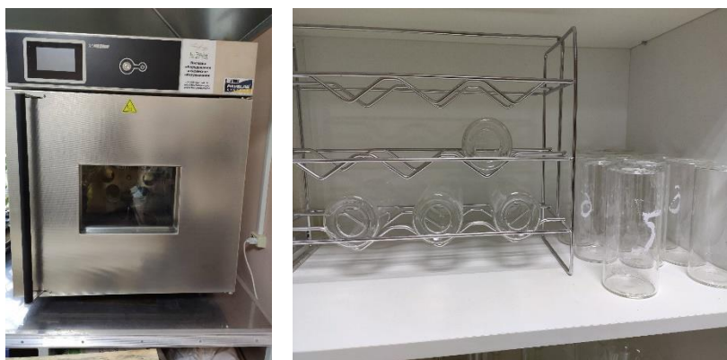
Рис. 7. Оборудование для определения старения битума при высокой температуре (метод RTFOT)
