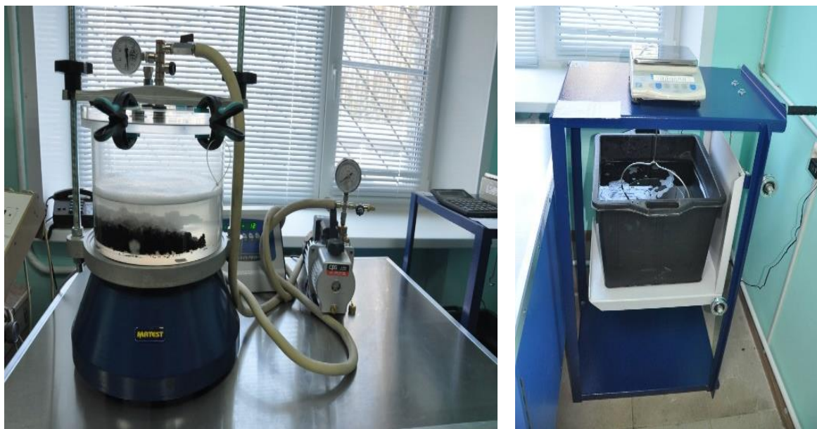
Рис. 12. Приспособление для гидростатического взвешивания образцов
