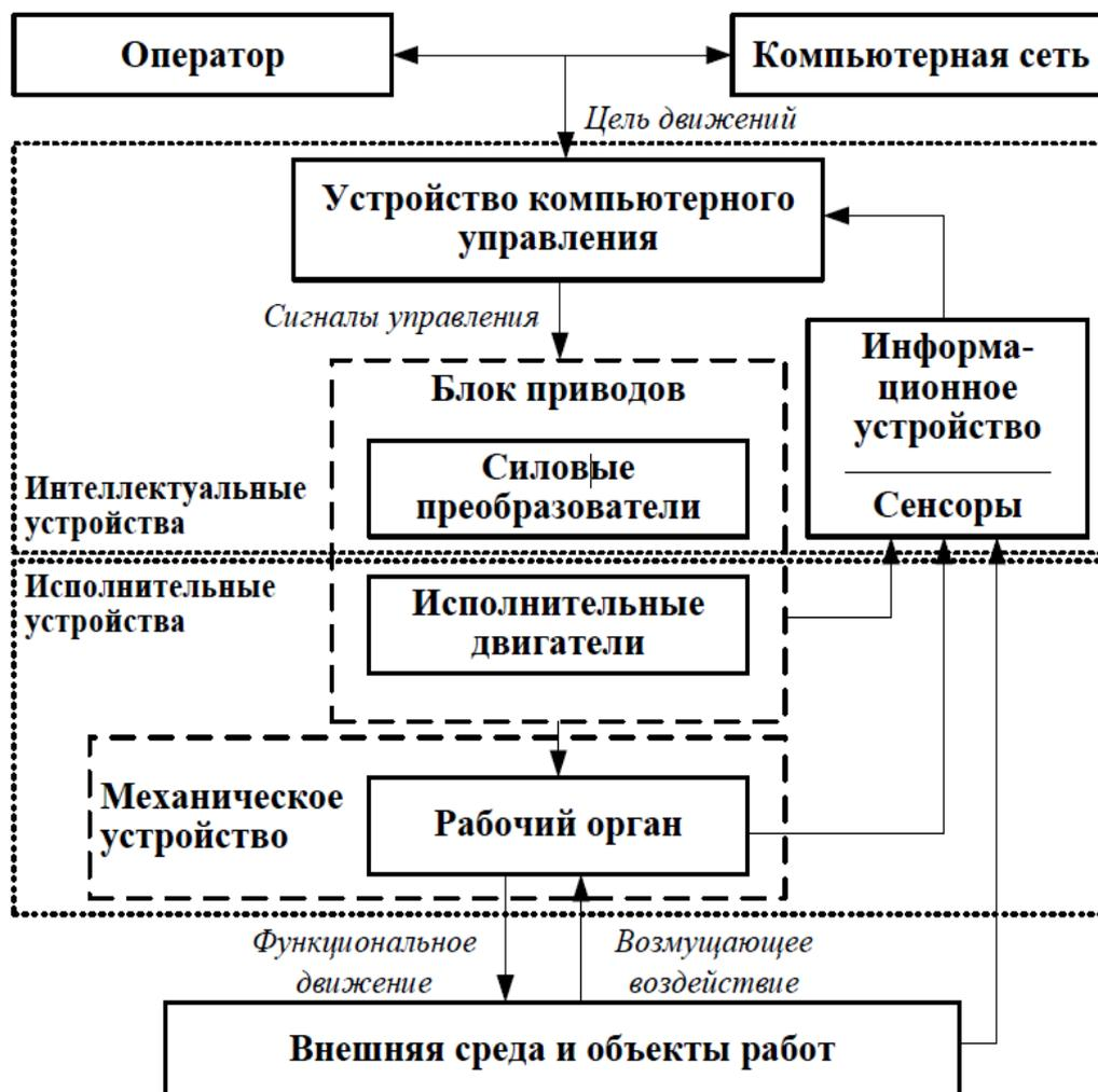
Рис. 1.1. Обобщенная схема мехатронной системы
