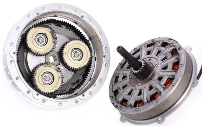
Рис. 4.4. Вид редукторного мотор-колеса
