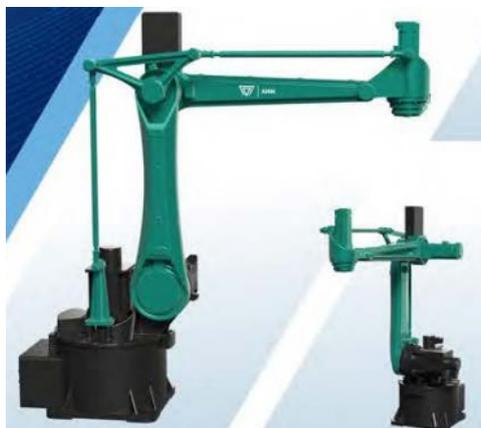
Рис. 4.17. Вид исполнительной системы манипулятора роботов серии «Фермион»
