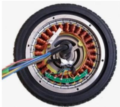
Рис. 4.5. Вид безредукторного мотор-колеса
