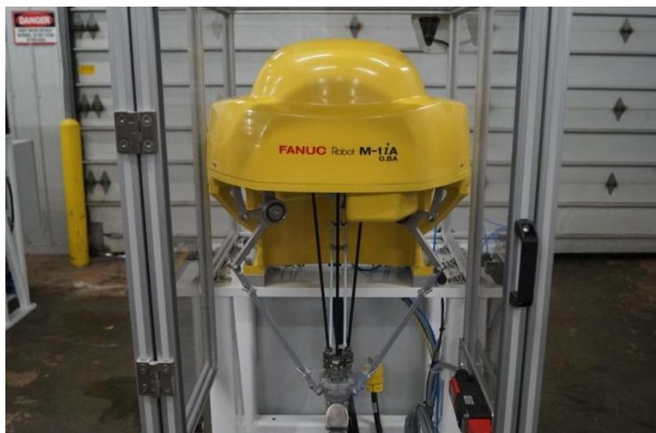
Рис. 1.22 Вид робота FANUC M-1iA
