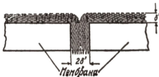
Рис. 1.4. Схема механизма избирательной сорбции растворителя на мембране и капиллярного течения через поры критического диаметра
