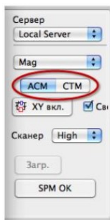
Рис. 15. Прибор переключен для работы по полуконтактным методам атомно-силовой микроскопии
