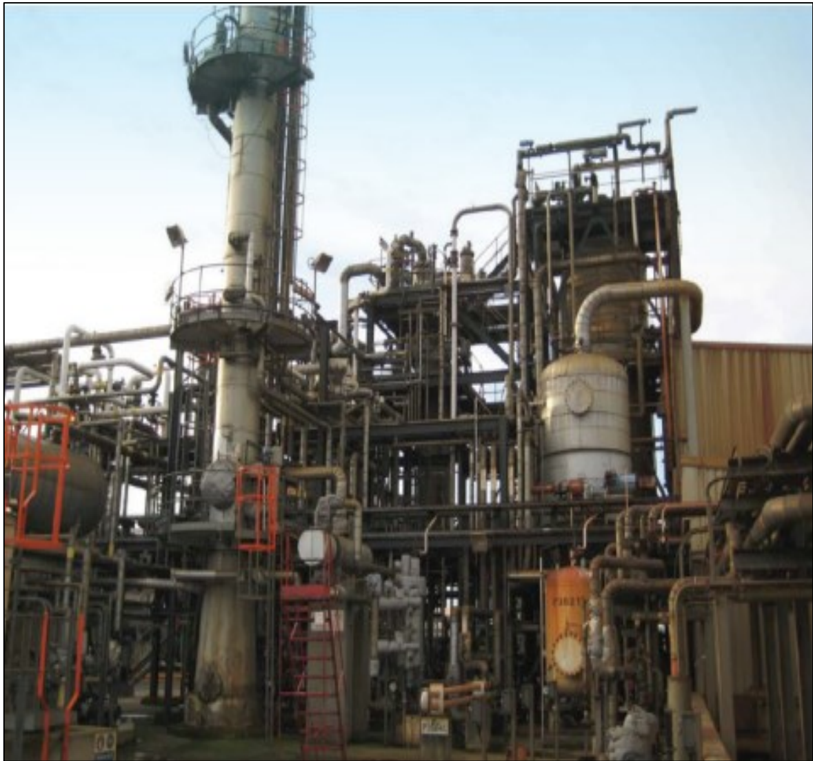
Рис. 28. Жидкостной скруббер Sulferox компании Shell для удаления сероводорода с помощью ионов железа \text{Fe (III)} и вспомогательное оборудование к нему [34]
