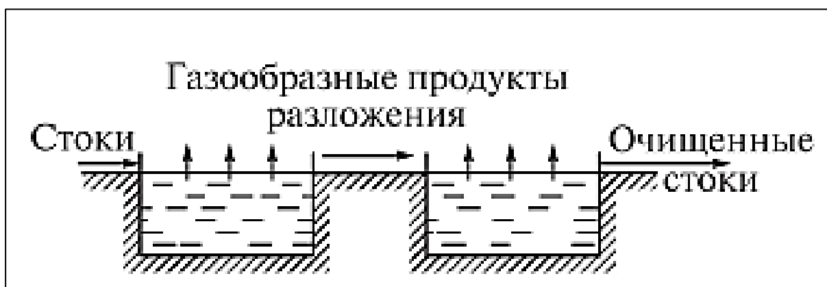
Рис. 78. Схема устройства анаэробных лагун [42]
