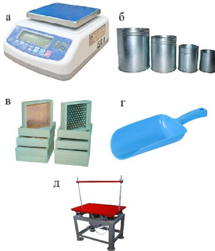
Рис. 16. Используемые приборы и оборудование: а – электронные весы; б – набор мерных цилиндров; в – стандартный набор сит с размерами отверстий 0,14; 0,315; 0,63; 1,25; 2,5 мм; г – металлический или пластиковый совок для отбора навески; д – виброплощадка
