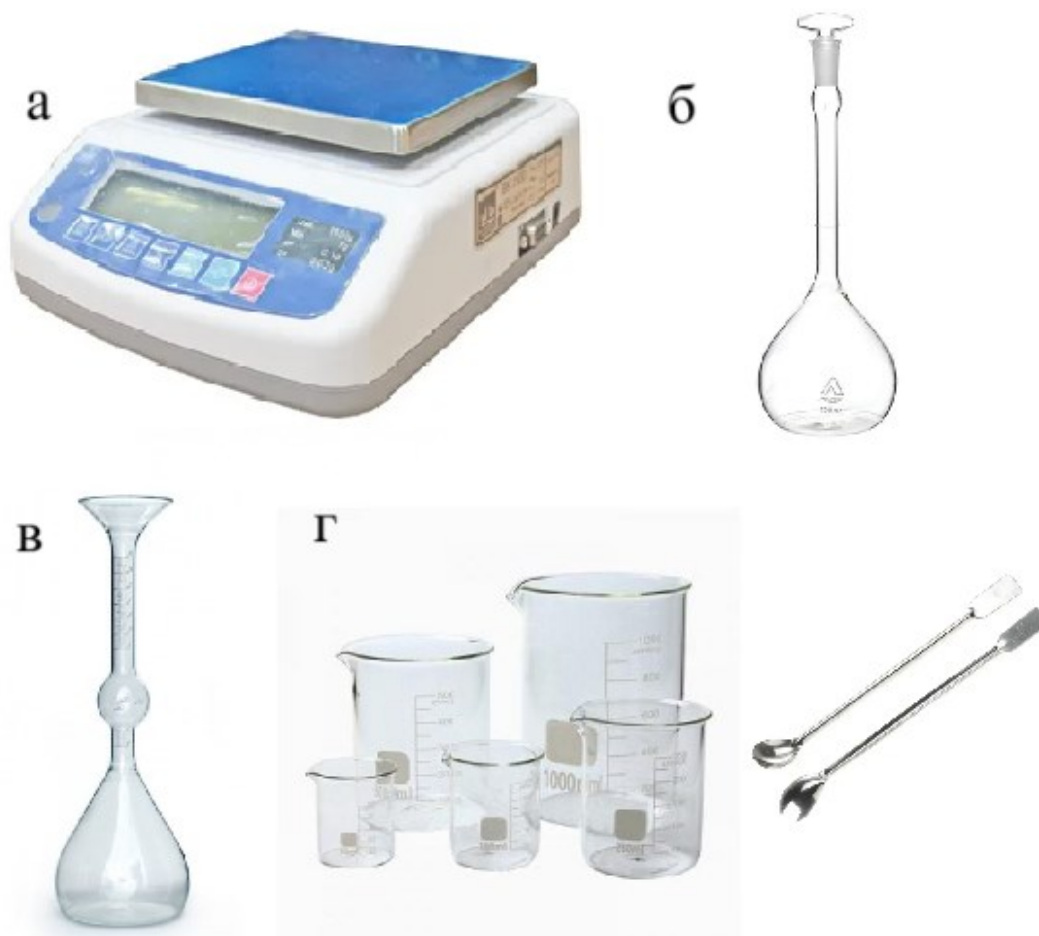
Рис. 4. Используемые приборы и оборудование: а – электронные весы; б – пикнометр; в – прибор Ле-Шателье; г – мерные стаканы и ложки для отбора навески;
