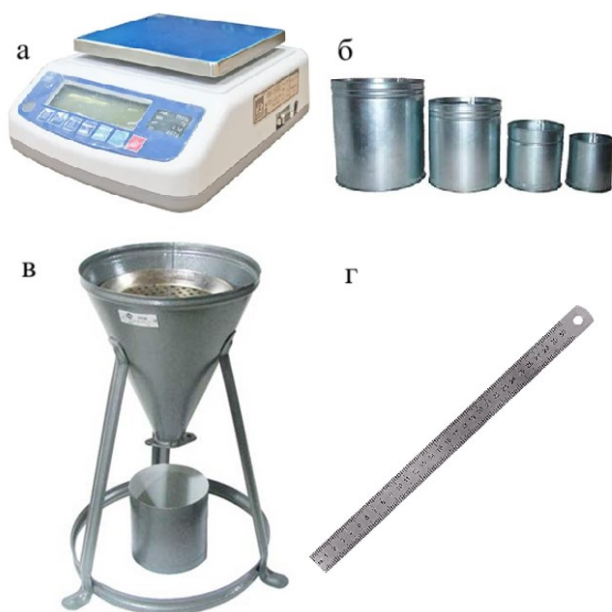
Рис.3. Используемые приборы и оборудование: а – электронные весы; б – набор мерных цилиндров; в – лабораторный конус; г – линейка
