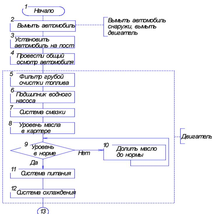
Рис. П 4. Пример оформления алгоритма контрольно-диагностических работ
