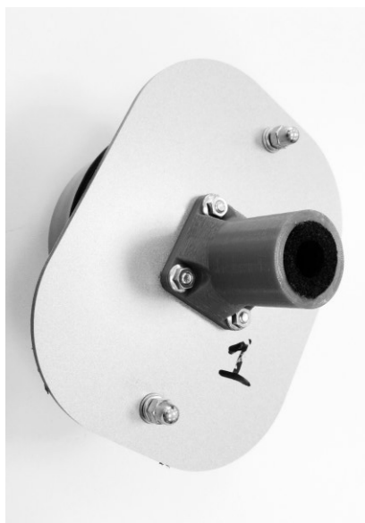
Рис. 3.3. Насадка для установки на микрофон противошумовых наушников
