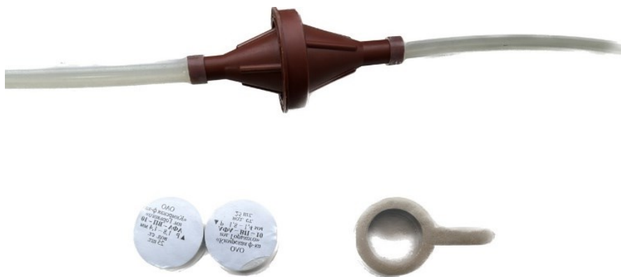
Рис. 5.2. Шланг с аллонжем для фильтров и фильтры АФА
