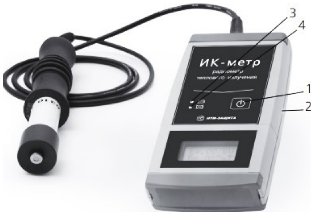
Рис. 7.1. Внешний вид радиометра: 1 – сенсорная кнопка включения/выключения; 2 – разъем для подключения блока питания; 3 – индикатор «заряд аккумуляторных батарей»; 4 – индикатор «сбой в процессе заряда»
