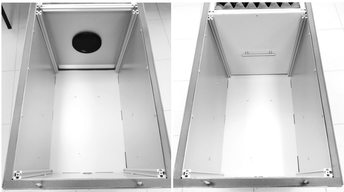
Рис. 3.2. Акустическая камера: а – вид изнутри камеры стенда; б – установка звукоизолирующей перегородки
