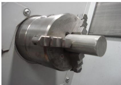
Рис. 10. Трехкулачковый самоцентрирующий патрон с заготовкой
