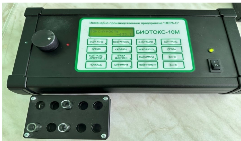
Рис.3. Определение токсичности по прибору «Биотокс-10М» (МП 29986-05)
