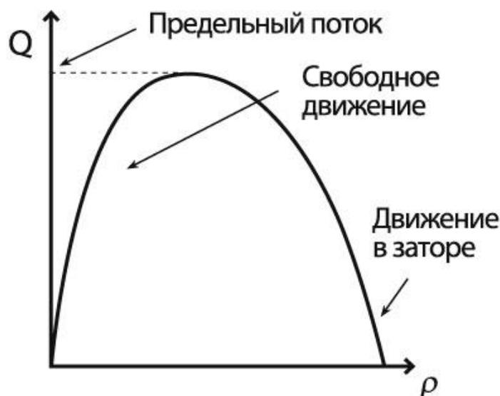
Рис. 7. Диаграмма состояния транспортного потока
