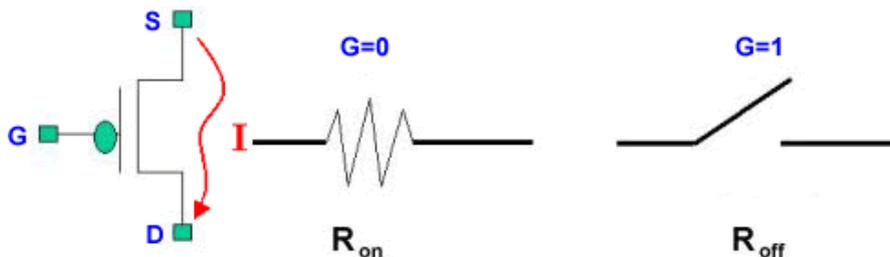
Рис. 1.26. Работа pМОП транзистора как ключа
