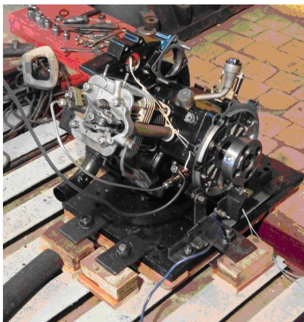
Рис. 1. Моторная установка для исследования процесса ручного пуска двигателя 1Ч 9,5/9,2
