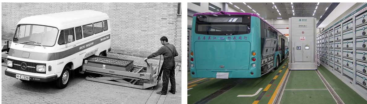
Рис. 1. Станция замены аккумуляторов электробусов
