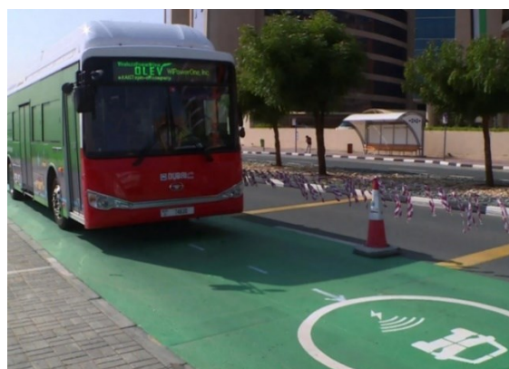
Рис. 4. Квазидинамическая беспроводная зарядка
