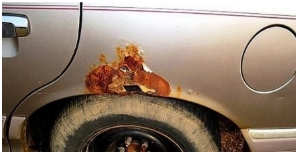
Рис. 2. Пример образования коррозии на крыле автомобиля
