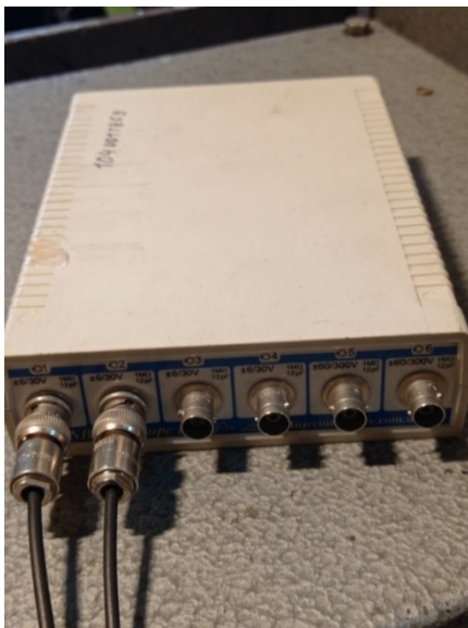
Рис. 2. Регистрирующая аппаратура: а) цифровой 6-канальный осциллограф «Постоловского»; б) персональный компьютер
