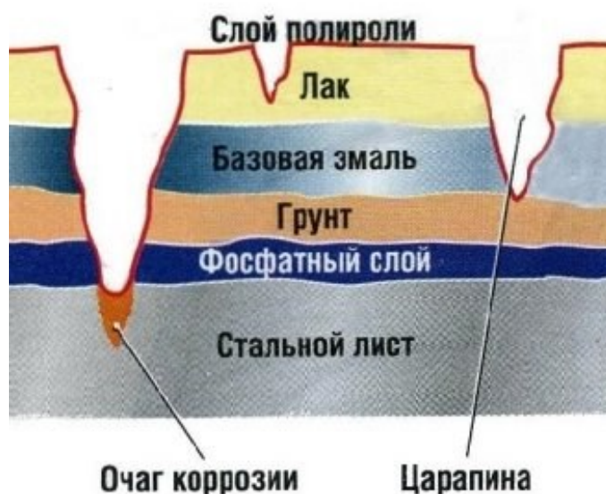
Рис. 3. Воздействие коррозии на кузов
