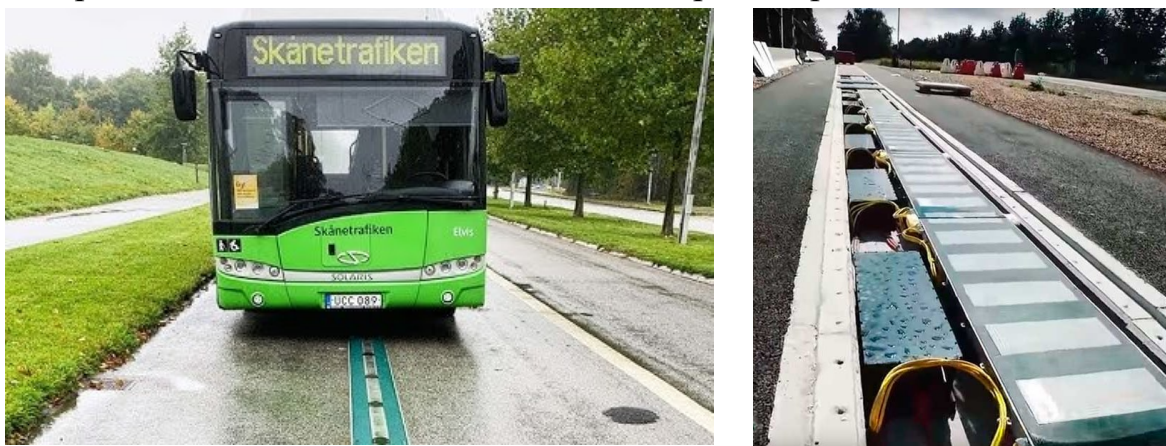
Рис. 5. Динамическая беспроводная зарядка
