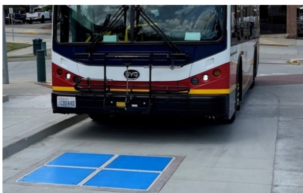
Рис. 3. Установка беспроводной зарядки
