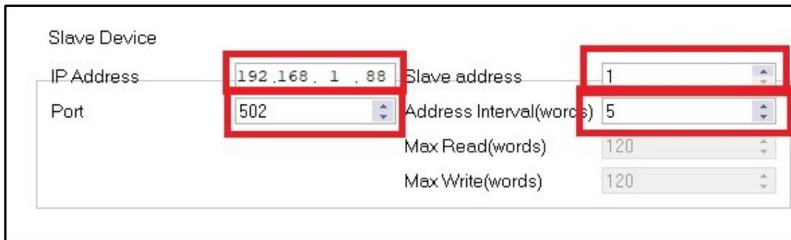
Рис. 4.29. Указание адреса контроллера
