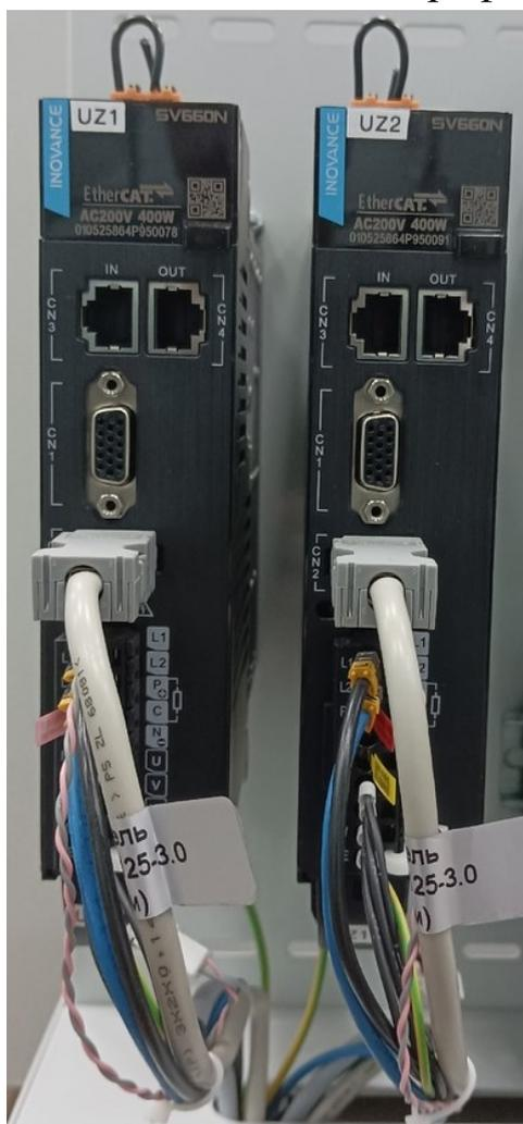
Рис. 1.5. Преобразователи частоты SV660N
