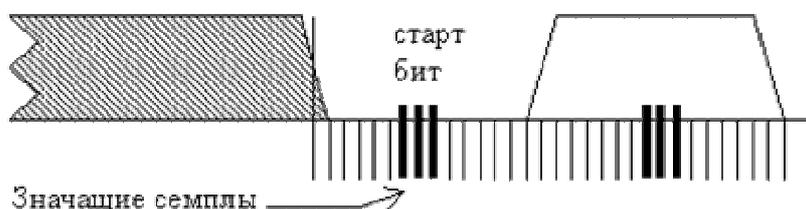
Рис. 5.3. Семплирование стартового бита
