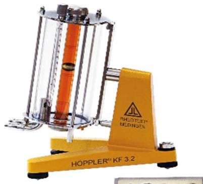
*Рис. 1.9. Вискозиметр Гепплера*
