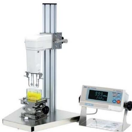
Рис. 1.11. Вибрационный вискозиметр
