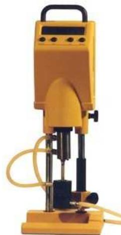
*Рис. 1.8. Автоматический капиллярный вискозиметр*
