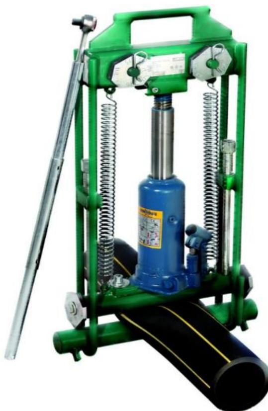
Рисунок 1 – Применение гидравлического передавливателя фирмы «Vigex»
