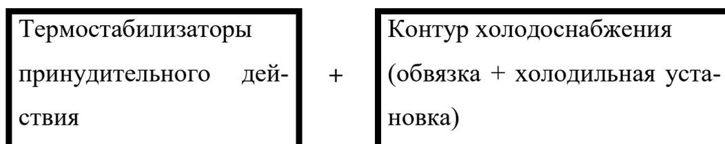
Рисунок 2 – Схема температурной стабилизации грунтов
