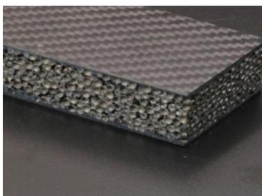
Рисунок 8 - Ячеистый композитный материал
