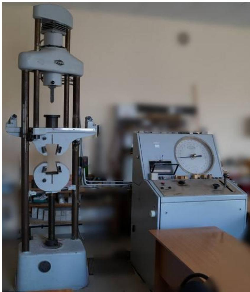
Рисунок 1 – Учебная испытательная машина УММ-10А
