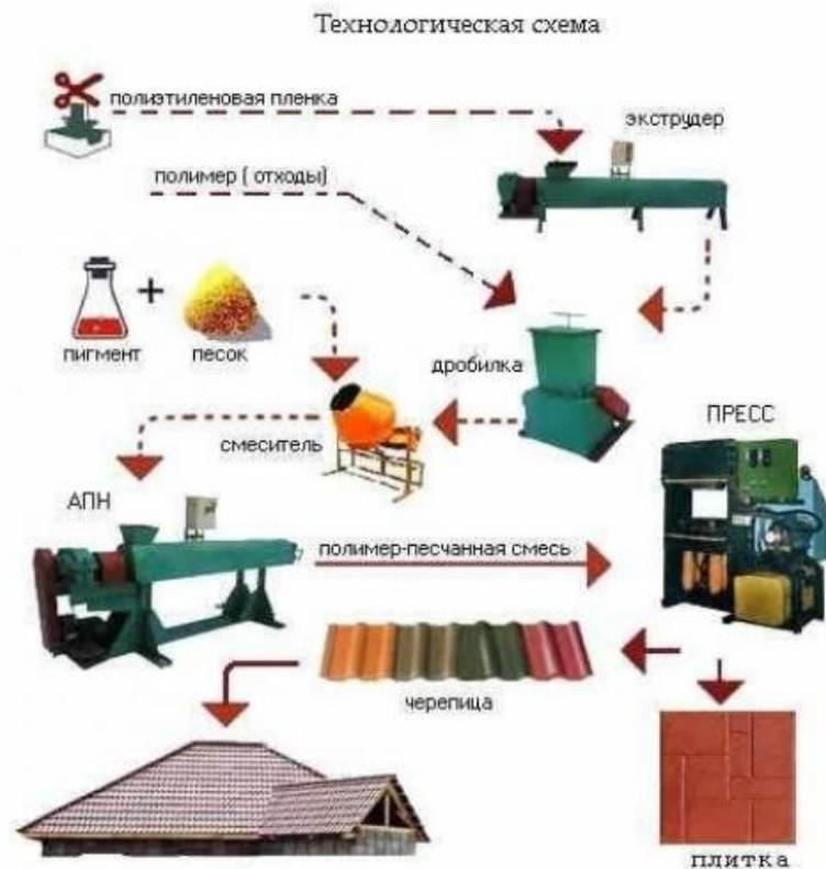
Рисунок 2 - Процесс производства полимерной плитки
