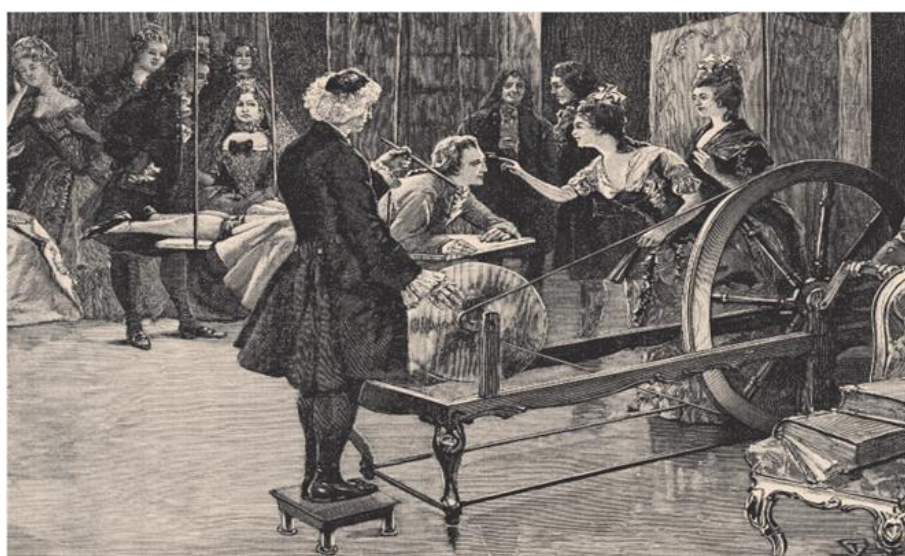
Опыты аббата Нолле с электрической индукционной машиной и лейденской банкой в Париже в начале XVIII века
