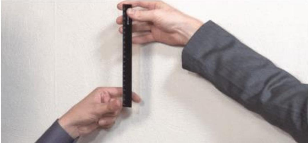
Линейка была поймана на делении 15 см. Это та высота, которую пролетела свободно падающая линейка, прежде чем удалось ее поймать. Значит, именно эта высота определяет время собственной реакции. Для того чтобы избежать случайных ошибок, необходимо повторить этот эксперимент несколько раз. Мы провели опыт три раза и определили время реакции
