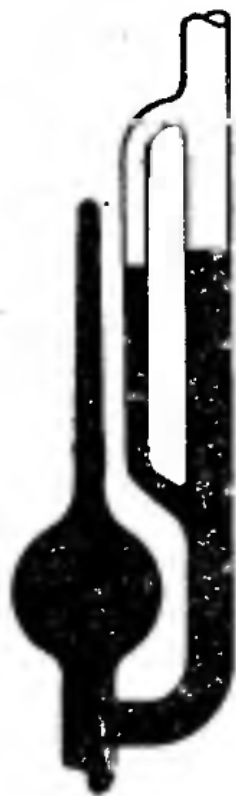
Рис. 29. Компрессионный манометр. Прилипание ртути [4, с. 210]
