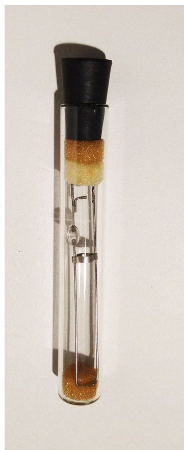
Рис. 85. Манометрический преобразователь ПМТ-6-3Ф. а) – съёмный цилиндрический баллон; б) – сменная запасная нить накала в стеклянном чехле [фото автора]
