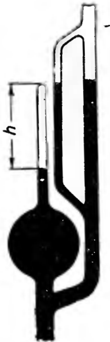
Рис. 20. Компрессионный манометр. Измерение давления методом квадратичной шкалы [4, с. 206]
