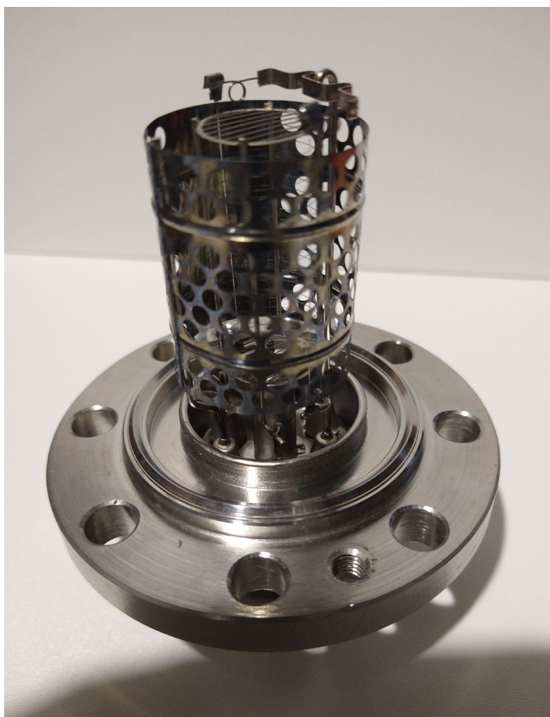
Рис. 122. Ионизационный манометрический преобразователь с осевым коллектором ПМИ-27 (в рабочем состоянии) [фото автора]
