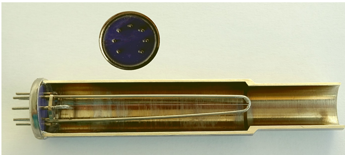
Рис. 76. Датчик Пирани с удалённой частью корпуса [ https://ru.wikipedia.org/wiki/Вакуумметр_Пирани ]
