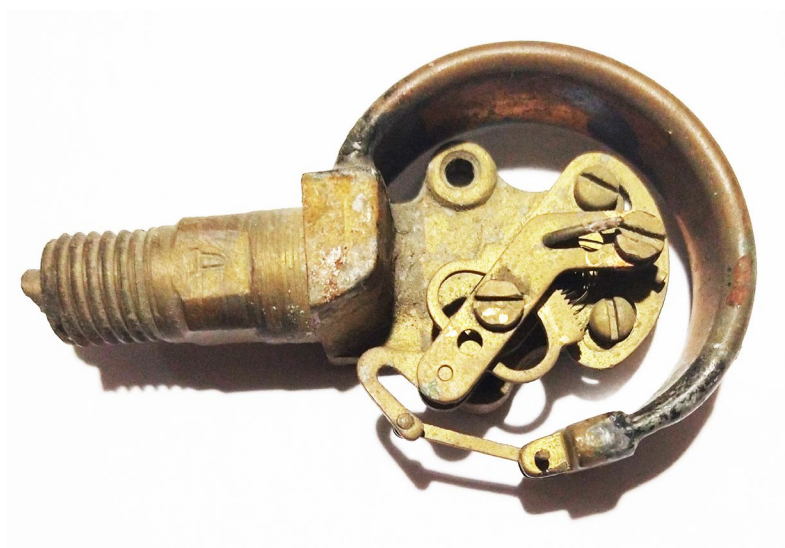
Рис. 33. Внутреннее устройство манометра Бурдона. Вверху – вертикальный вид, внизу – горизонтальный [фото автора]
