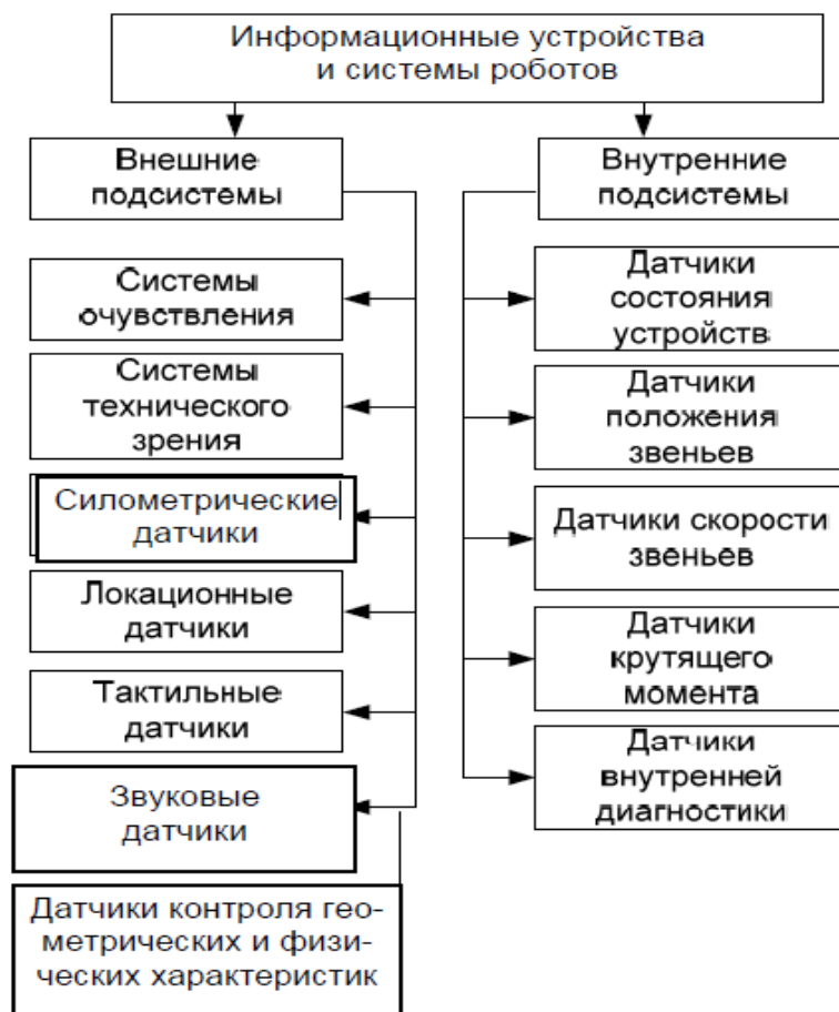
Рис. 2.39 Классификация информационных устройств и систем используемых в мехатронике и промышленных роботах
