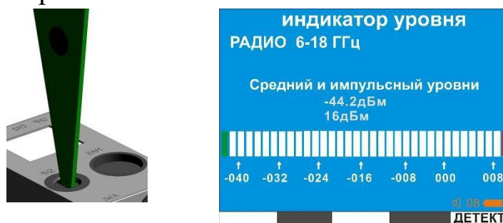
Рис.6. Контроль канала «РАДИО 6-18ГГц»
