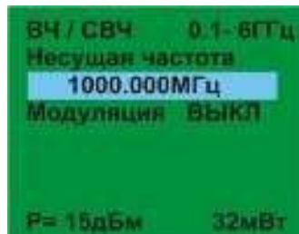
Рис. 13 Подменю работы с сигналами в диапазоне частот 0.1-6ГГц
