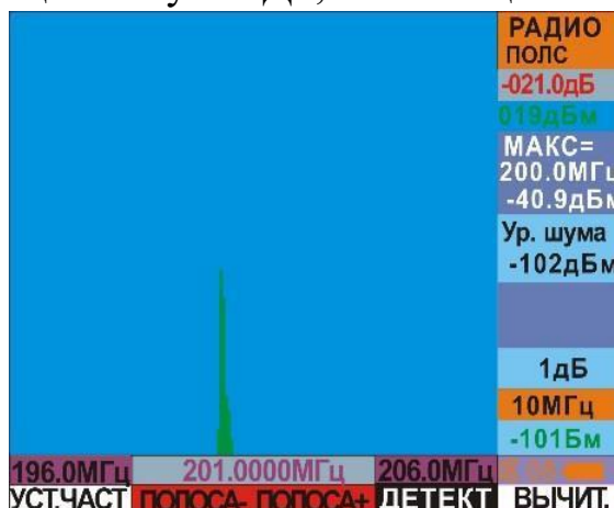
Рис.3. Проверка сигнала 200МГц на устройстве ST131.S.TEST
