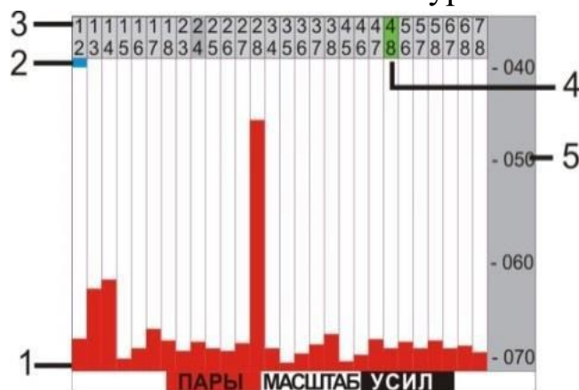
Рис.2. Последовательный контроль уровня сигнала во всех возможных парах
