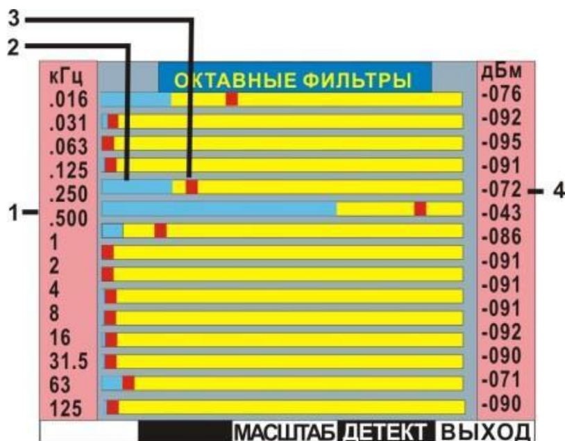
Рис.1. Индикации уровня акустических сигналов с использованием октавных фильтров
