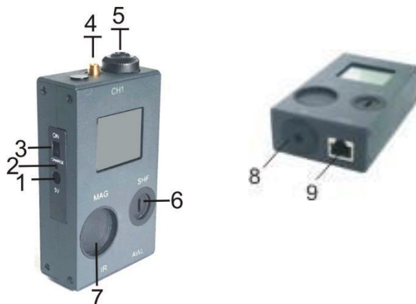
Рис.1. Разъемы и индикаторы устройства ST131.S.TEST
