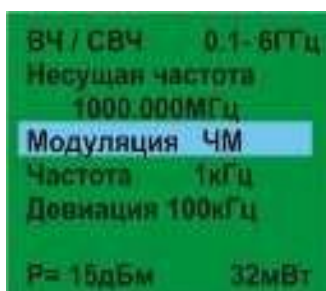
Рис. 14 Выбор типа модуляции несущего сигнала
