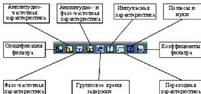
Рис. 59. Управляющие кнопки для отображения характеристик и параметров фильтров
