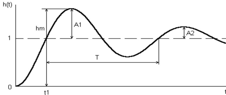
Рис. П4. Измеряемые отрезки на колебательной переходной функции
