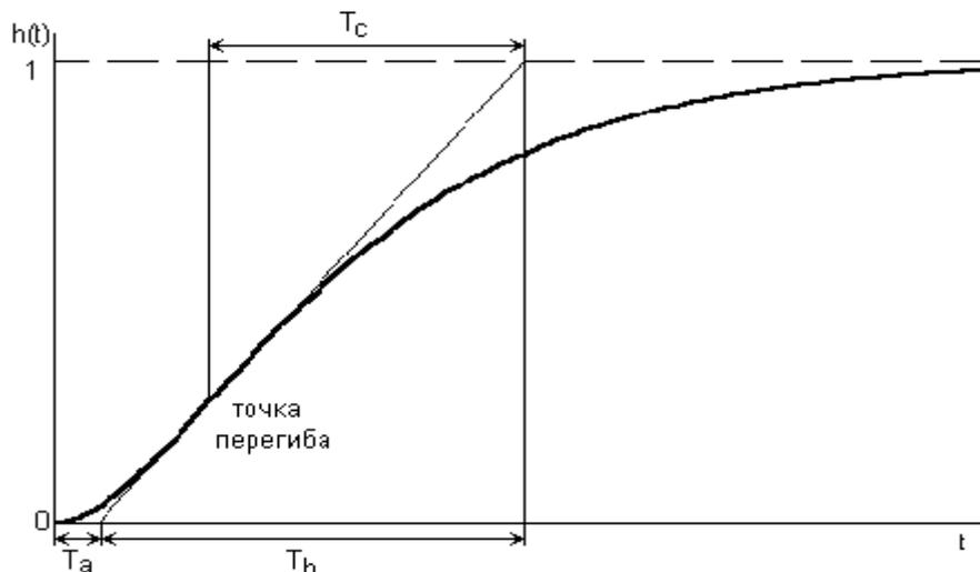
Рис. П1. Измеряемые отрезки на экспериментальной переходной функции
