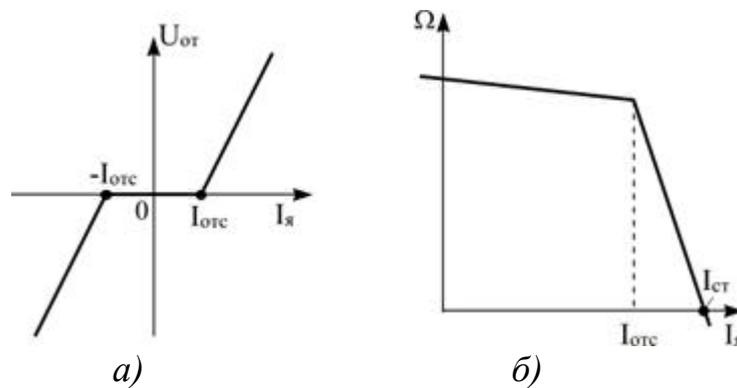
Рис. 16. Формирование токовой отсечки (а)
