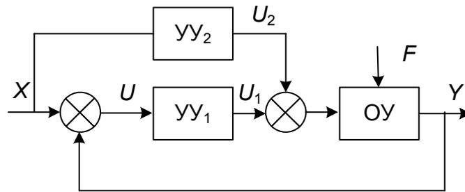
Рис. 10. Функциональная схема следящей системы с комбинированным управлением
