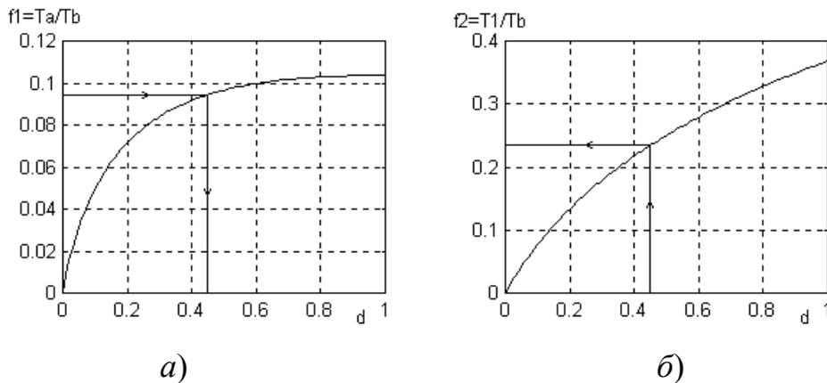
Рис. П2. Графики для вычисления постоянных времени по отрезкам  $T_a$  и  $T_b$
