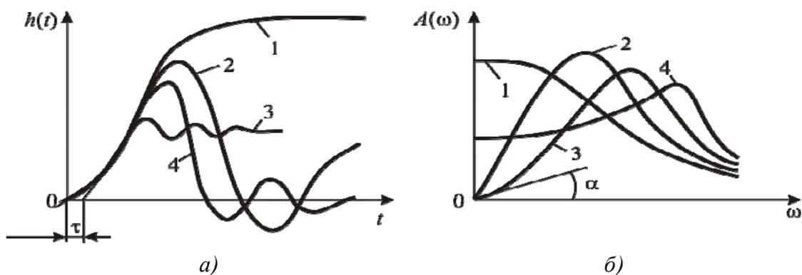
Рис. 5. Качество регулирования в одноконтурных АСР для стационарных объ-
