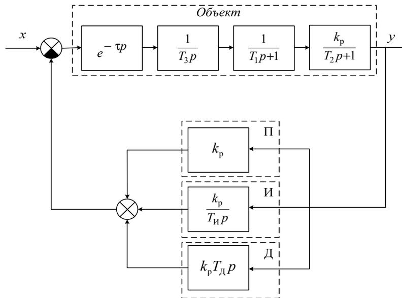
Рис. 19. Структурная схема автоматизированной системы для построения переходных характеристик
