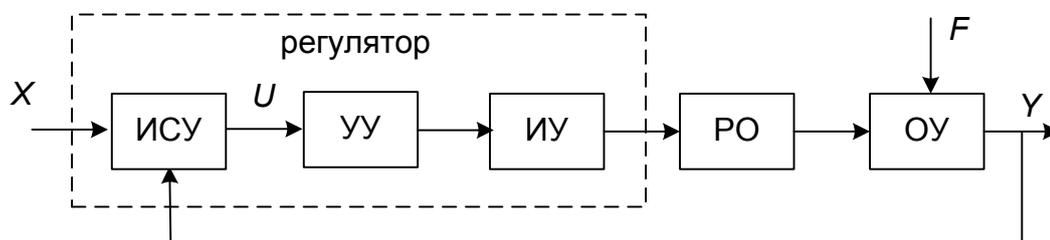
Рис. 8. Управление по замкнутому циклу
