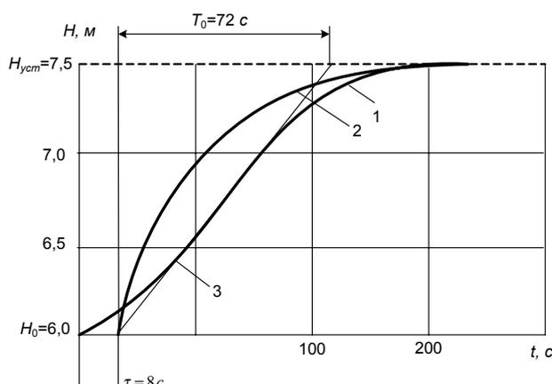
Рис. 17. Временные характеристики гидравлического объекта управления по уровню: 1 – экспериментальная кривая; 2 – эквивалентная кривая; 3 – точка перегиба
