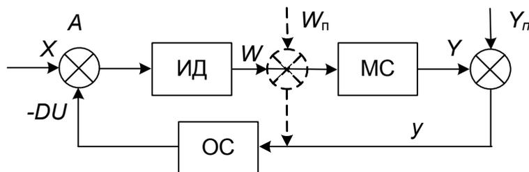
Рис. 9. Управление на входе исполнительного двигателя
