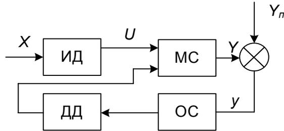
Рис. 12. Функциональная схема системы с кинематическим управлением
