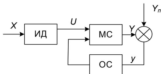
Рис. 11. Функциональная схема системы с силовым управлением
