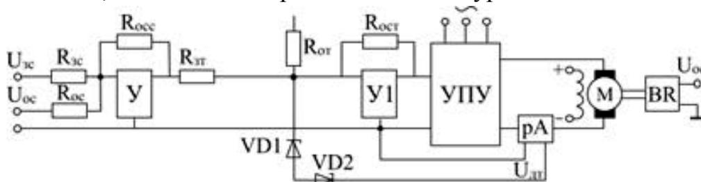
Рис. 15. Функциональная схема с отсечкой по току
