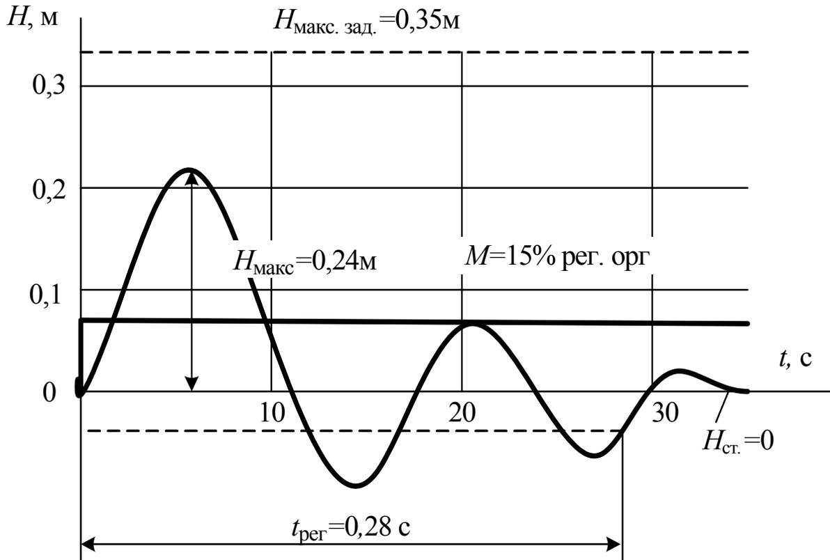
Рис. 18. Характеристика переходного процесса в АСР уровня гидравлического объекта, полученная расчетом на ЭВМ
