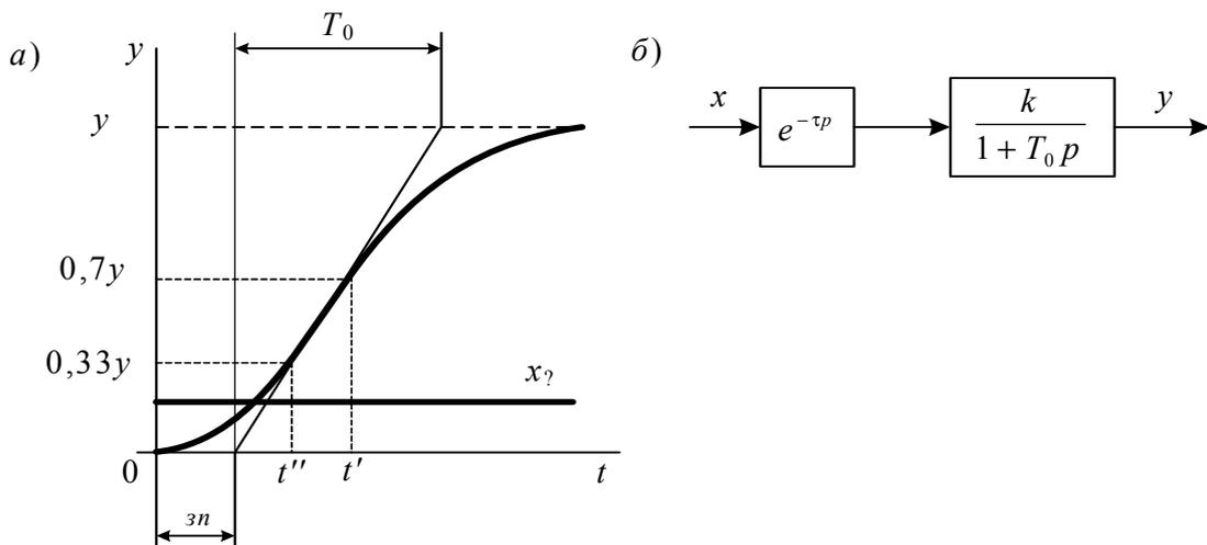
Рис. 2. Определение по экспериментальной временной характеристике параметров (а) и структуры (б) объекта управления
