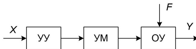
Рис. 6. Управление по разомкнутому циклу
