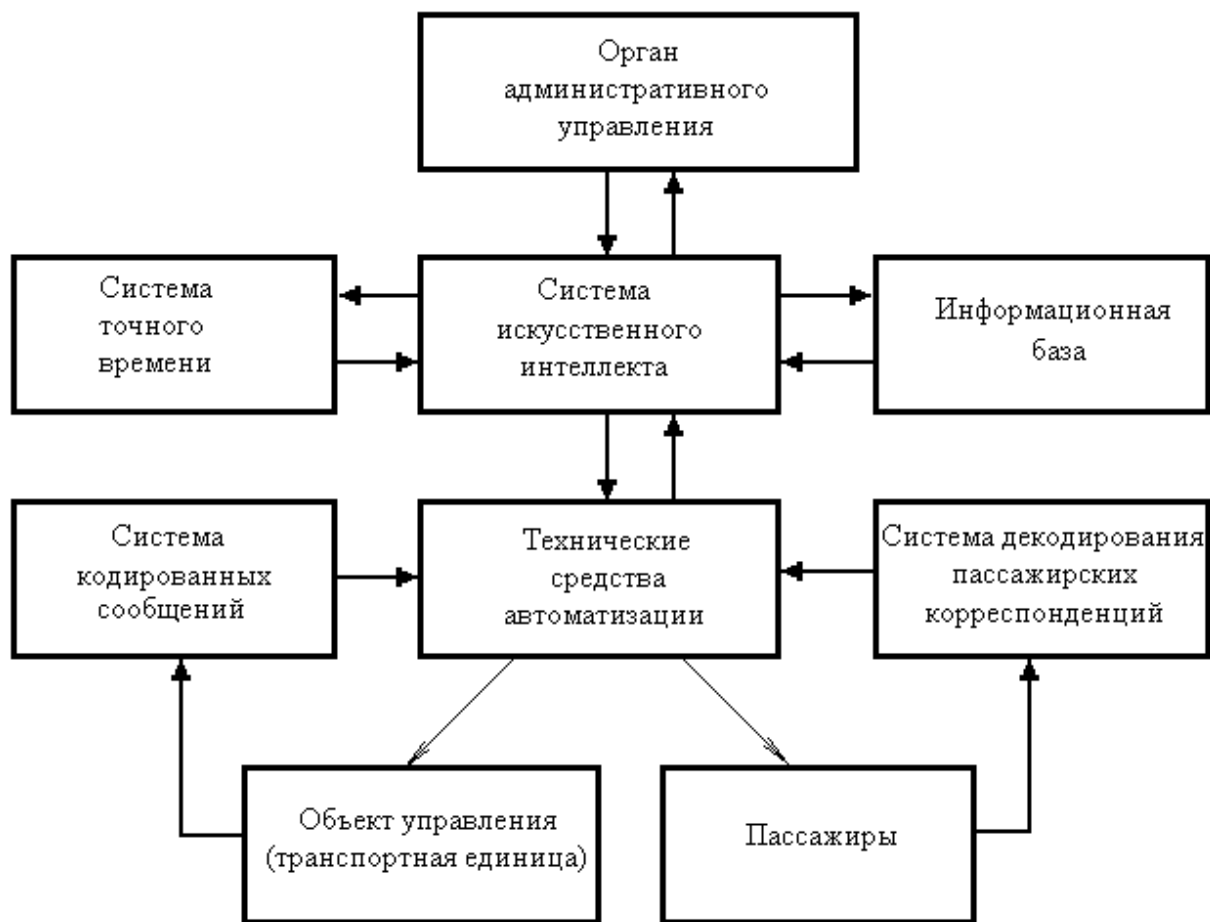
Рис. 1.2. Структура и состав связей автоматической системы диспетчерского управления
