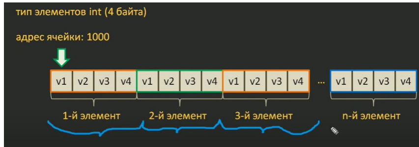
Рис.35в Расположение элементов статического массива.
