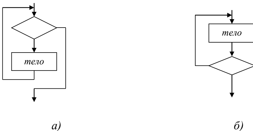
Рис. П4.3. Алгоритмическая структура «цикл»: а – цикл с предусловием; б – цикл с постусловием
