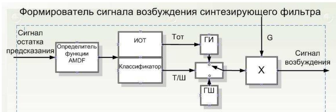
Рис. 5.4. Формирователь сигнала возбуждения синтезирующего фильтра
