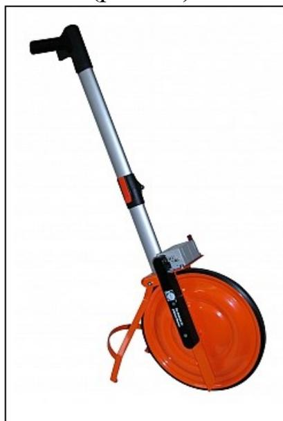
Рис. 23. Измерительное колесо SK3
